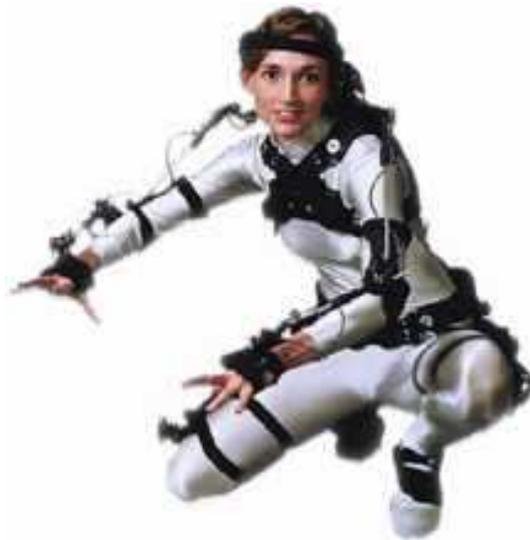
Figura 27 – Exemplo de *motion capture* por processo mecânico – Gypsy
