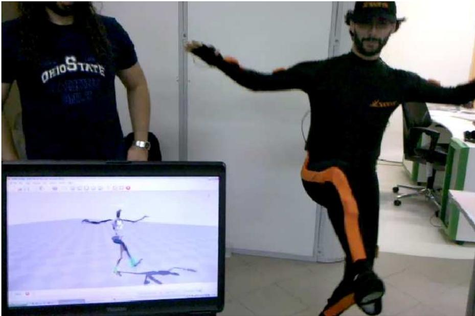
Figura 26 – Captura de movimento através de sistema magnético
