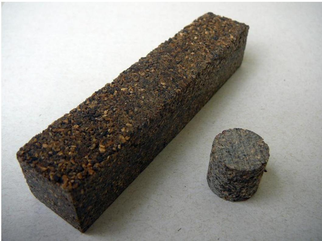
Figura 48 – Copos de prova para ensaio de abrasão. Fonte: Anne Mello, 2013.
