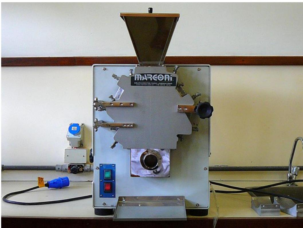
Figura 33 – Moinho de rotor vertical com facas móveis e fixas. Fonte: Anne Mello, 2011.
