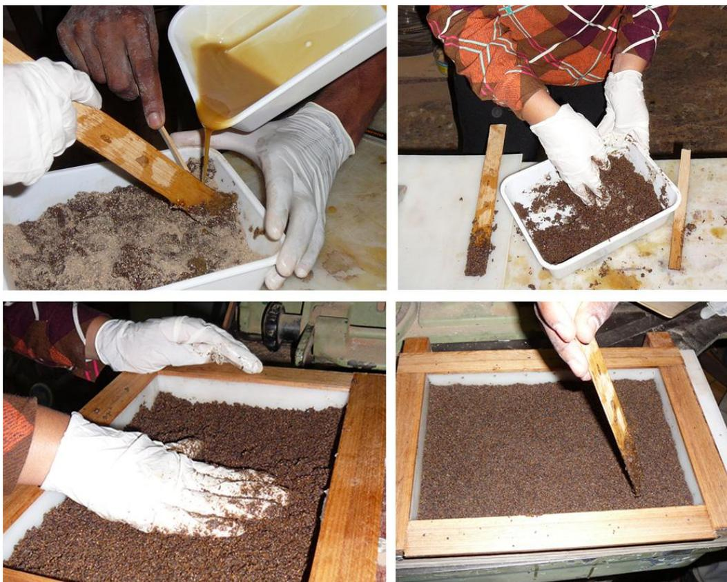
Figura 41 – Mistura e moldagem da massa. Fonte: Anne Mello, 2012.
