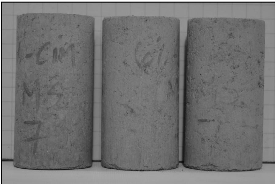
Figura 64. Imagem dos corpos de prova, solo/CIM-D7, ao final dos ciclos de molhagem e secagem.
