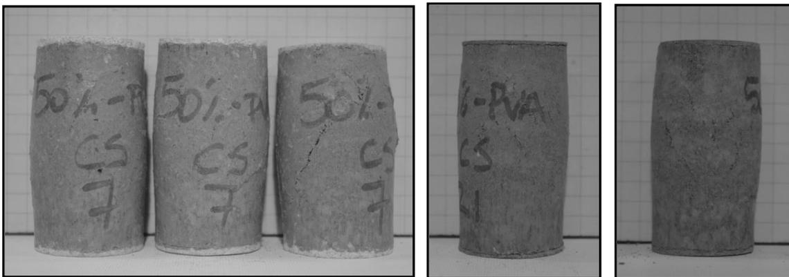
Figura 34. Corpos de prova solo/PVA50, aos 7, 21 e 35 dias.
