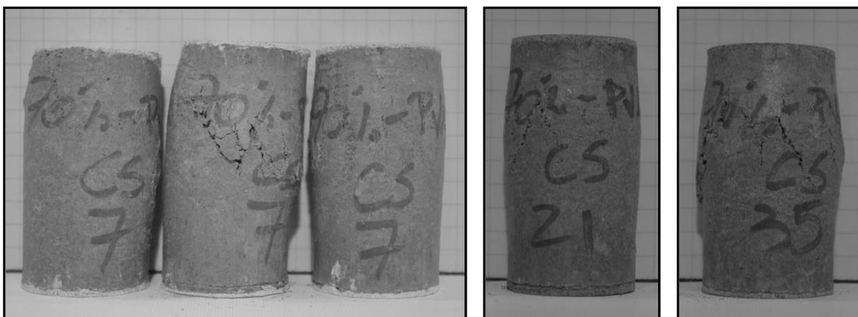
Figura 36. Corpos de prova solo/PVA70, aos 7, 21 e 35 dias.
