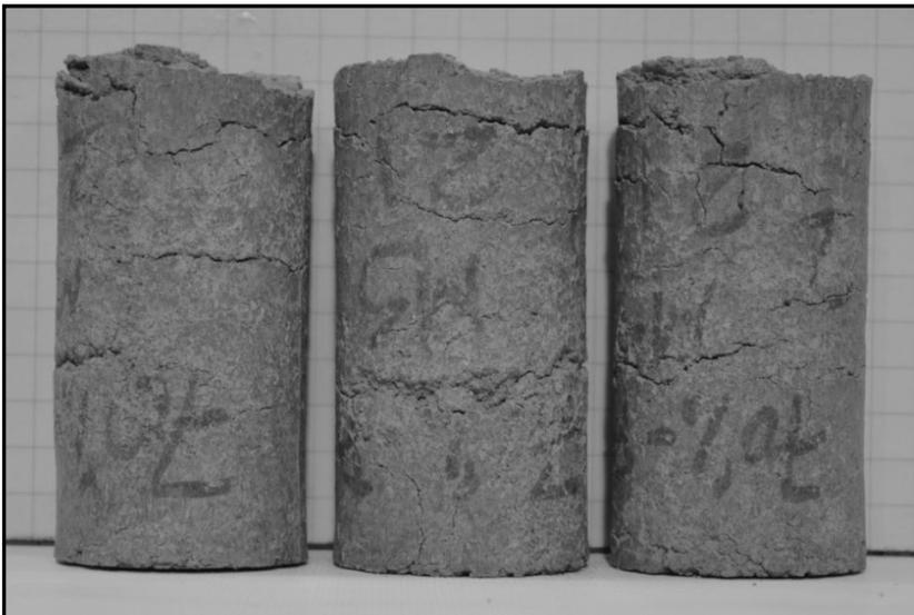
Figura 66. Imagem dos corpos de prova, solo/PVA70-D21, ao final dos ciclos de molhagem e secagem.
