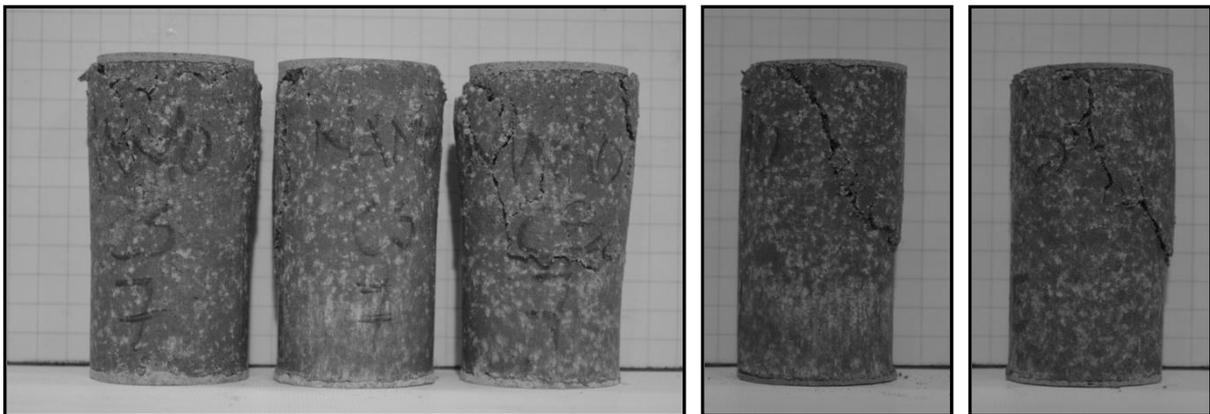
Figura 38. Corpos de prova solo/RPM, aos 7, 21 e 35 dias.
