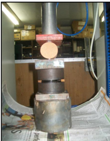
Figura 25. Ensaio de tração por compressão diametral (PINTO, 2008).
