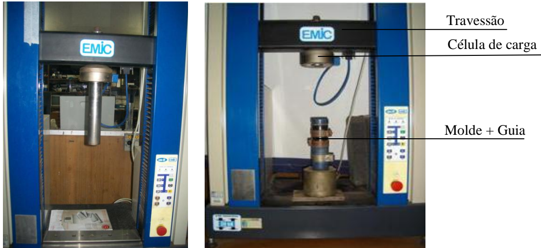
Figura 23. Máquina universal de ensaios utilizada para a compactação (PINTO, 2008).
