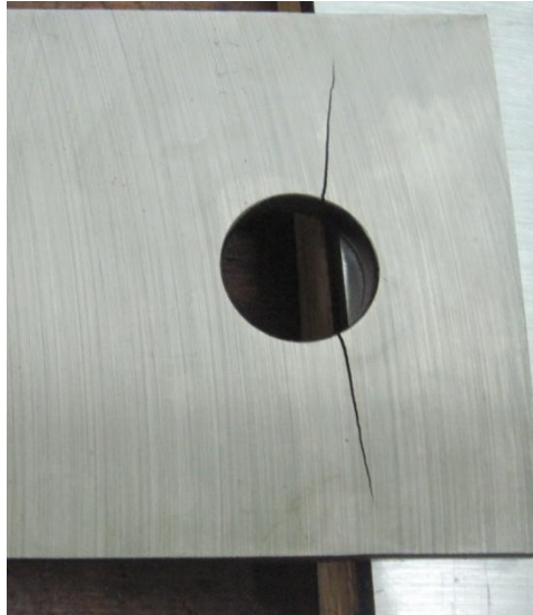
Figura A3. 5 – Trinca no furo do CP05.
