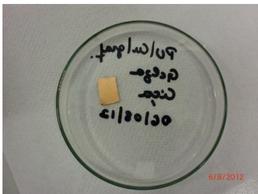
Figura 22 - solução de PU sobre amostra de cobre com grafeno
