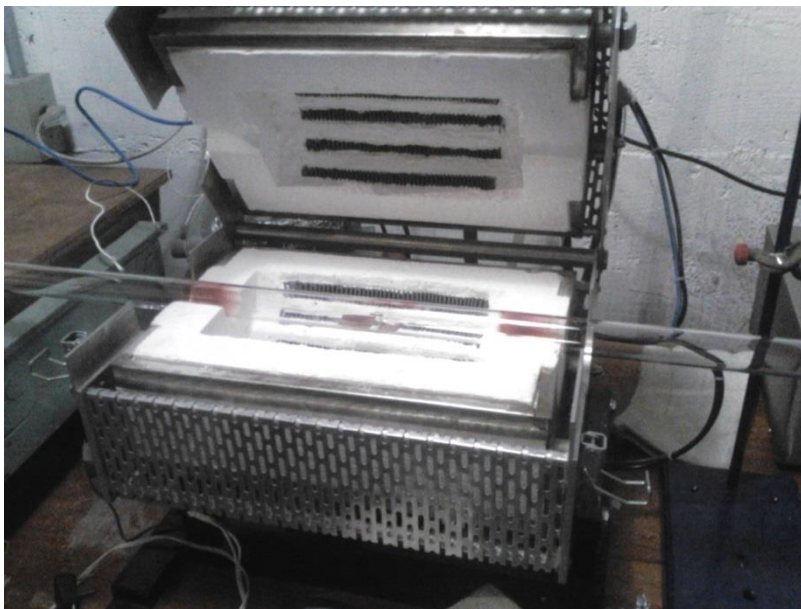
Figura 16 - Foto da câmara de CVD aberta, com tubo de quartzo contendo dois pedaços de folha de cobre
