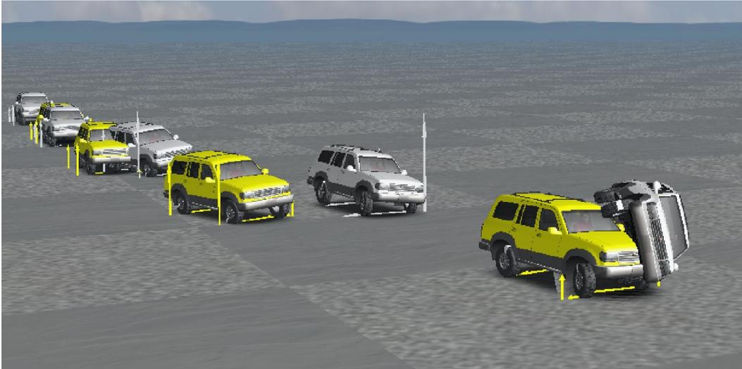
Figura 1.1: Simulação de um veículo realizando uma manobra tipo "Fishhook". O veículo amarelo está com RSC e o cinza sem RSC.
