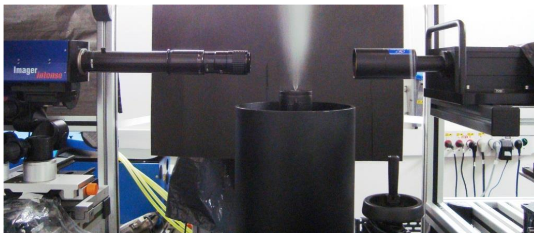
Figura 25 Montagem experimental empregada para medição da distribuição de tamanho de gotas e velocidades com Shadowgraphy.
