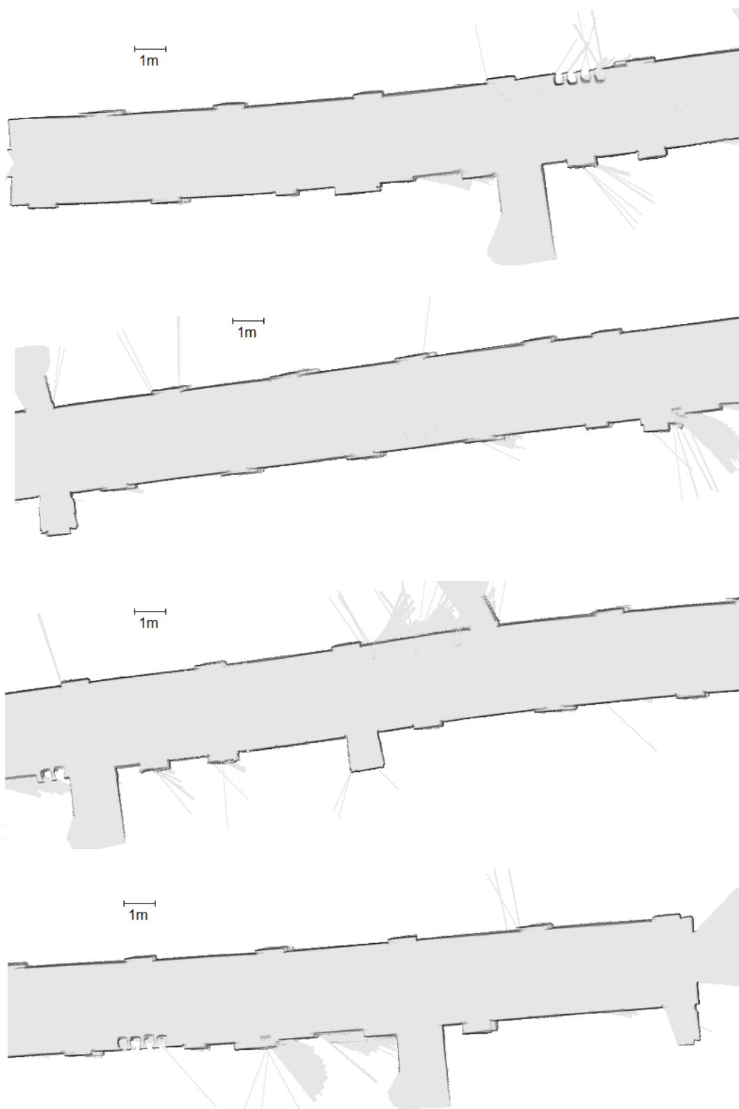
Figura 5.19: Detalhes do Mapa 2D do ambiente da segunda experiência obtido usando o algoritmo DP-SLAM
