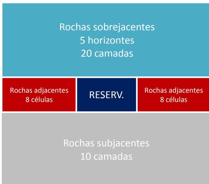
Figura 1.4 Representação esquemática do modelo geomecânico. [15]
