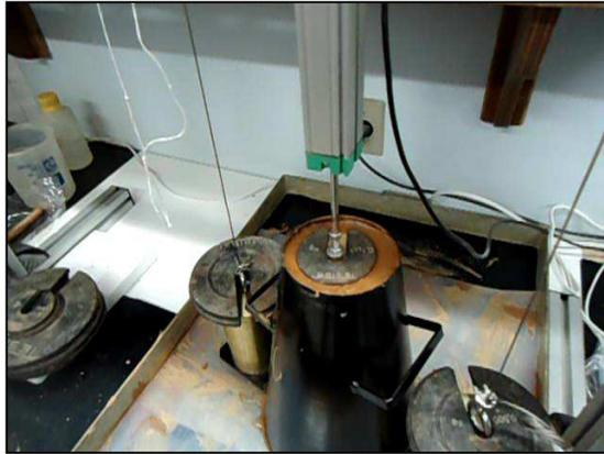
Figura 46 - Ensaio realizado com a colocação de um peso adicional no disco que faz contato solo/transdutor com a finalidade de aumentar a velocidade de deslocamento da haste
