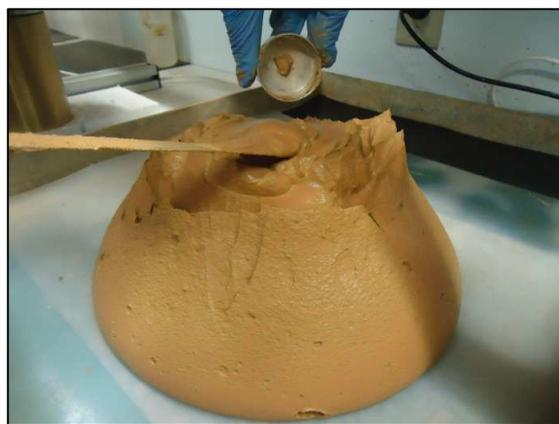
Figura 56 - Coleta de material para determinação da umidade
