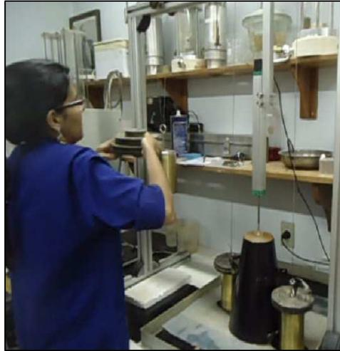
Figura 55 - Colocação do peso para ascensão do cone
