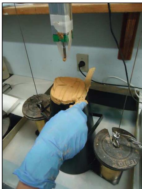
Figura 54 - Acabamento da superfície superior do tronco de cone
