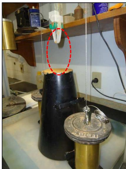
Figura 57 - Espaço existente entre o transdutor e o tronco de cone
