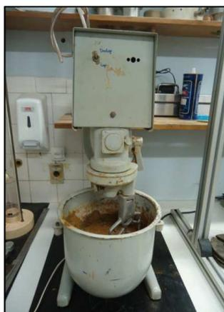
Figura 51 - Preparação da amostra: mistura água e solo
