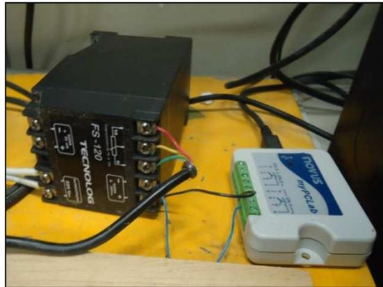
Figura 44 - Transdutor para potenciômetro, a esquerda, e sistema de aquisição de dados a direita
