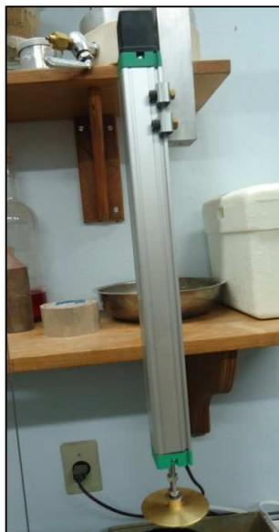
Figura 43 - Transdutor linear e disco de latão utilizados nesta configuração
