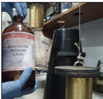
Figura 52 - Glicerina a ser utilizada nas paredes internas do tronco de cone
