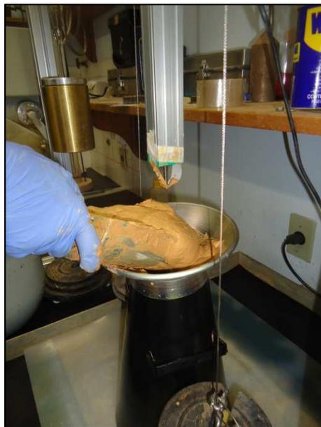
Figura 53 - Preenchimento do tronco de cone
