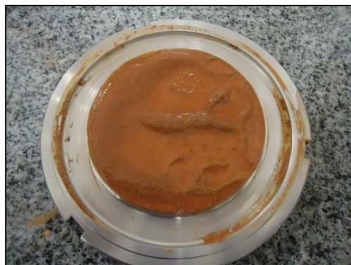
Figura 34 - Lâminas de água formadas pela sedimentação do material
