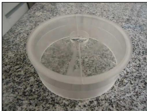
Figura 35 - Capa protetora de acrílico utilizada para minimizar a exposição da amostra ao ar condicionado
