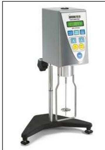
Figura 26 - Viscosímetro Brookfield modelo DV I Primer
