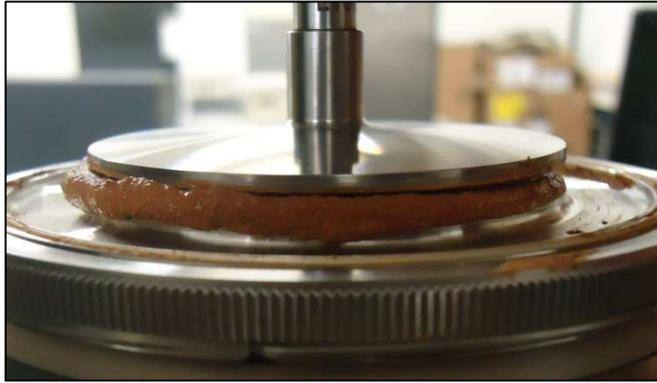
Figura 30- Extravasamento de material no ensaio utilizando uma folga de 4,0mm
