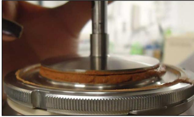
Figura 32 - Indicativo do ressecamento do material durante o ensaio: espaço vazio entre as placas
