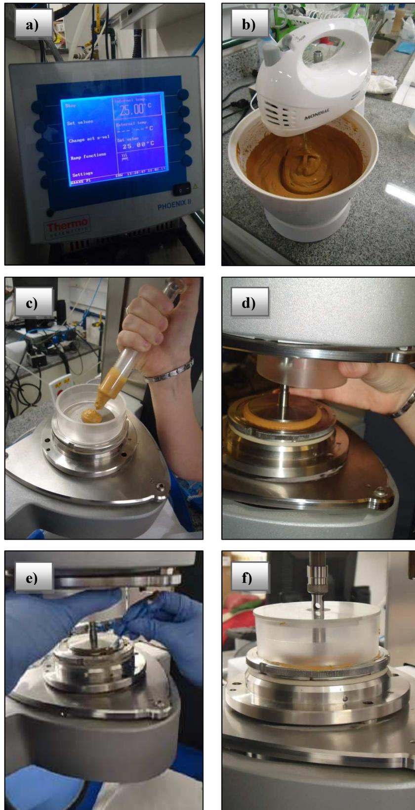
Figura 36 - Etapas do procedimento experimental estabelecido para os ensaios no reômetro: a) regularização da temperatura; b) homogeneização do material; c) colocação da amostra na placa inferior; d) espalhamento do material; e) limpeza da lateral da geometria; f) colocação da capa protetora e início do ensaio
