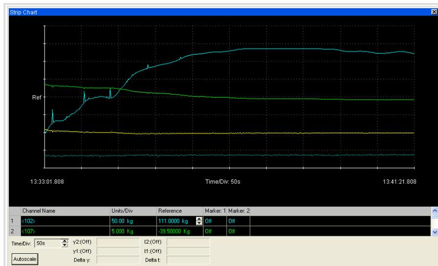
Figura 4.23 - Pulsos de carga medidos pelas células instaladas no topo da base e do subleito para o pavimento reforçado com o subleito compactado na unidade ótima.
