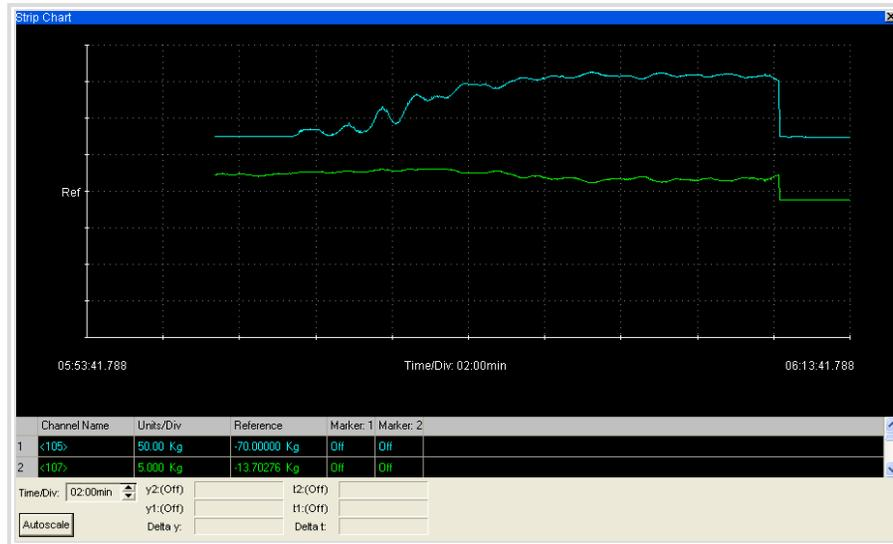
Figura 4.21 – Exemplo de pulsos de carga medidos pelas células instaladas no topo da base e do subleito para o pavimento não reforçado com o subleito compactado na unidade ótima.
