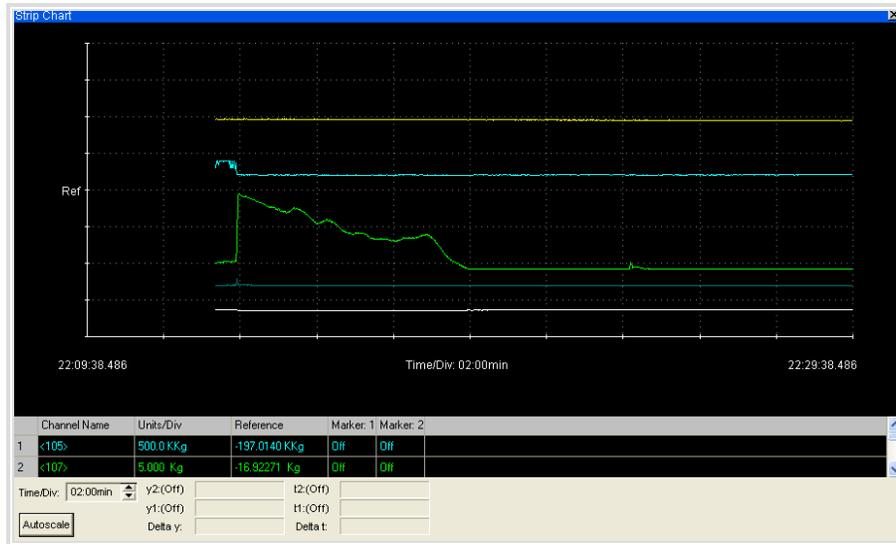
Figura 4.22 – Pulsos de carga registrados pela célula (C-105) onde indica que sua capacidade nominal foi superada.
