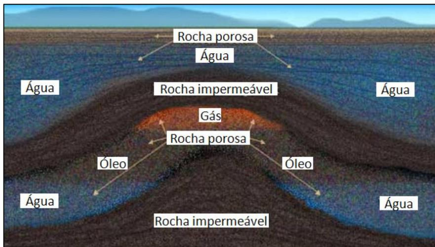
Figura 2.2: Disposição dos fluidos em um reservatório de petróleo
