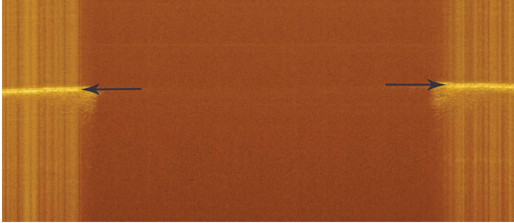
Figura 4.8: Imagem 2D do padrão de calibração de abertura de 3 mm. As setas indicam os limites da abertura.
