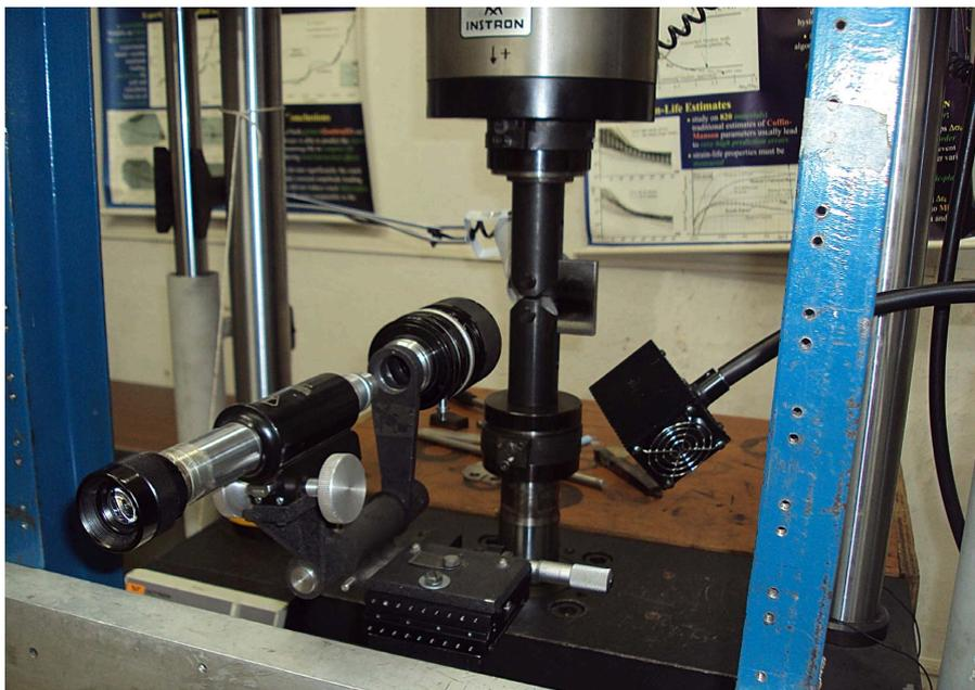
Figura 3.26: Lente de aumento óptico utilizado para visualização do aparecimento de trincas.
