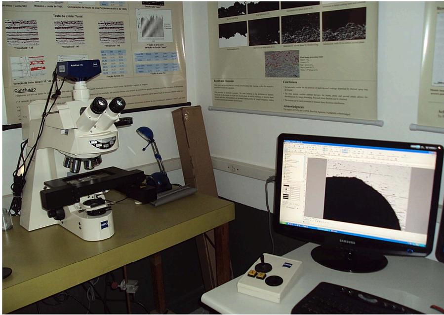
Figura 3.27: Microscópio óptico utilizado para visualização de eventuais trincas não-propagantes.
