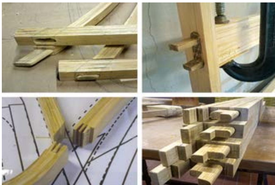
Figura 4: Vários tipos de encaixes
