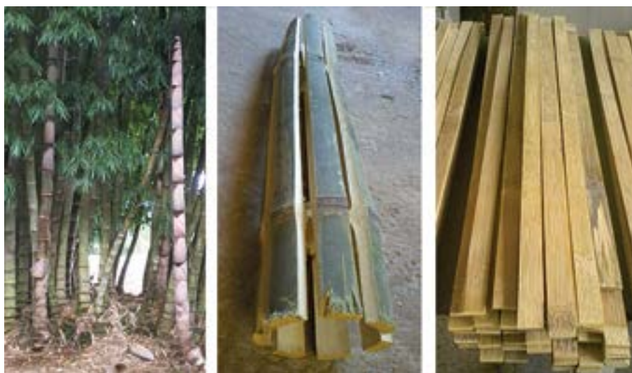
Figura 1: Moita de Bambu Gigante, colmo destopado/refilado e ripa laminada
