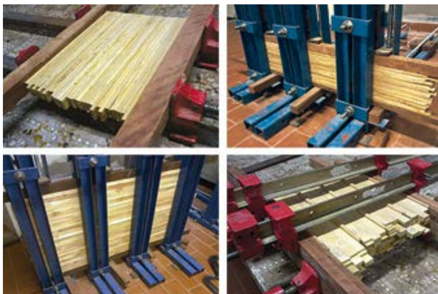
Figura 2: Diferentes formas de colagem
