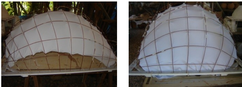
Figura 95: Modelo escala 1:6, com base de 1,30 x 1,00m e altura de 54cm.
