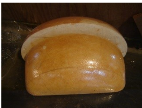
Figura 103: Meias-formas da estrutura interna e da sobrecobertura, mostrando suas proporções, já forradas com filme de PVC. À direita, uma meia forma concluída.
