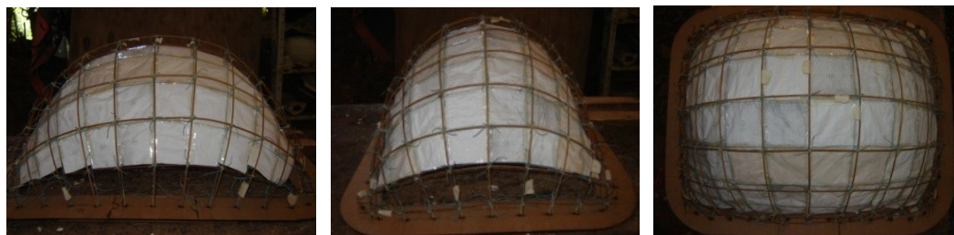
Figura 96: Maquete com peças de papel coladas que reproduzem mantas de fibrobarro compondo a forração interna.
