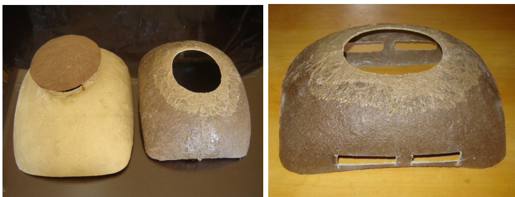
Figura 105: Carapaça com claraboia. À direita, vãos de entrada e saída de ar no molde da forração interna.
