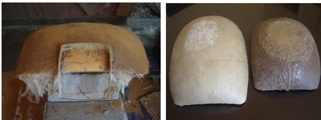
Figura 104: Uma tentativa (abandonada) de moldar a carapaça com a gola da claraboia. Moldes unidos da estrutura e molde inteiro da sobrecobertura.
