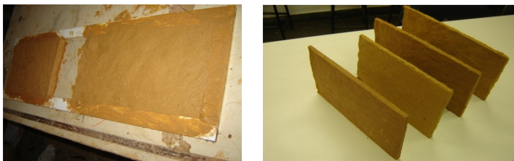
Figura 19: Gabarito com 1 cm de altura e fundo forrado com filme plástico para permitir a retração do barro sem que ocorresse o seccionamento da placa apenas com o barro. Placas enfileiradas.
