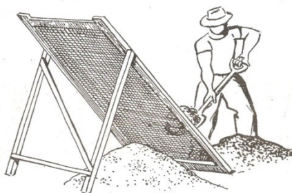
Figura 14: Croquis de uma ciranda (peneira grossa, geralmente com malha de \frac{1}{4} ", formando ângulo em torno de 60^\circ com o chão, que pode conter outras malhas, dependendo da destinação do material peneirado). Imagem extraída de Milanez (1958, p. 24).
