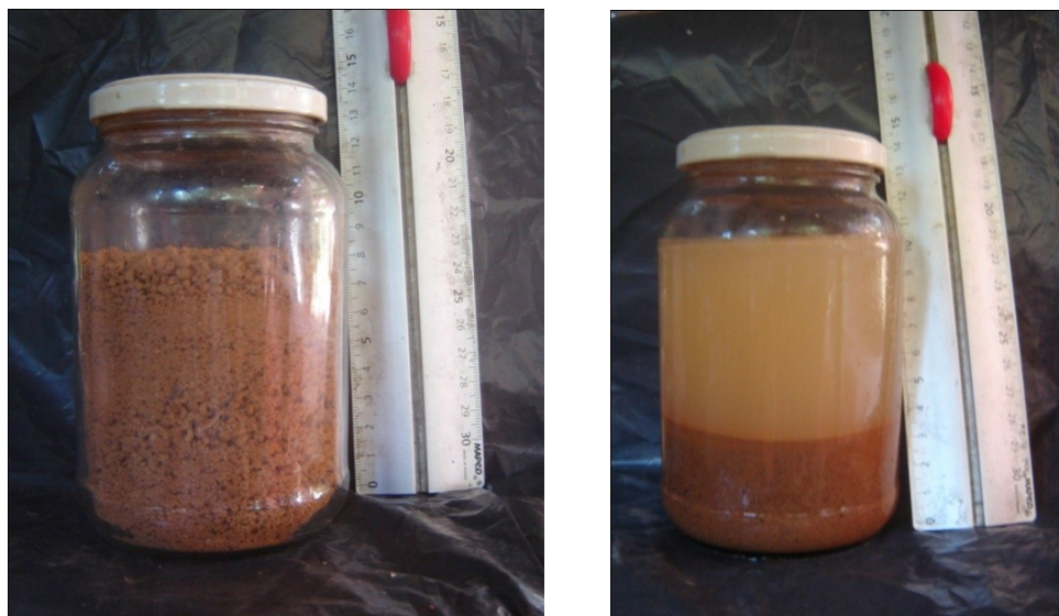
Figura 13: Teste feito com barro extraído do barranco ao lado do campo de futebol do campus da PUC-Rio, evidenciando elevado teor de silte e argila.
