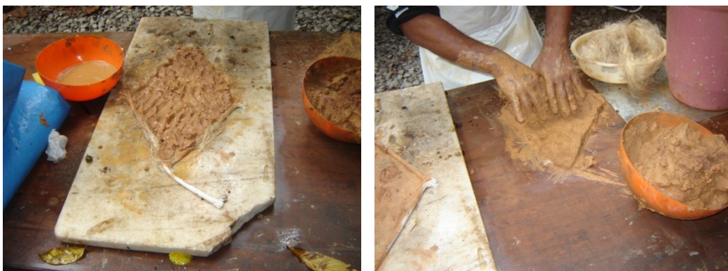
Figura 12: O gabarito preenchido, percebendo-se as marcas superficiais da pressão dos dedos. A manta já retirada do gabarito, recebendo o tratamento superficial.
