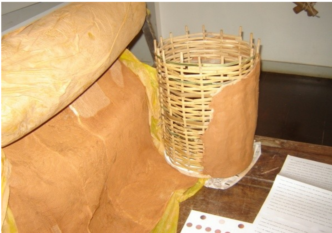
Figura 9: Manta de fibrobarro em exposição 1 , como elemento de vedação para reservatórios d'água (SANTOS, V.J., 2012, p. 28).
