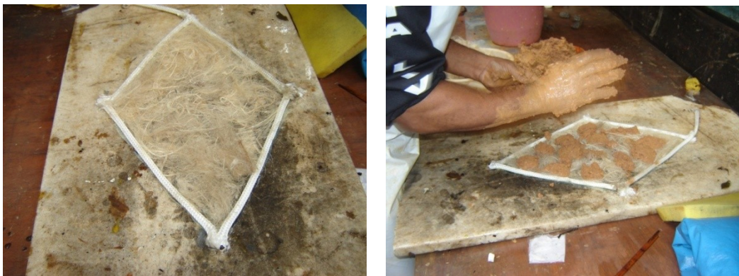
Figura 10: Gabarito losangular feito de corda com 10mm de espessura, colada sobre pedra-mármore, com fibras de sisal espalhadas aleatoriamente no interior do gabarito. Lançamento de punhados da mescla de barro sobre as fibras.
