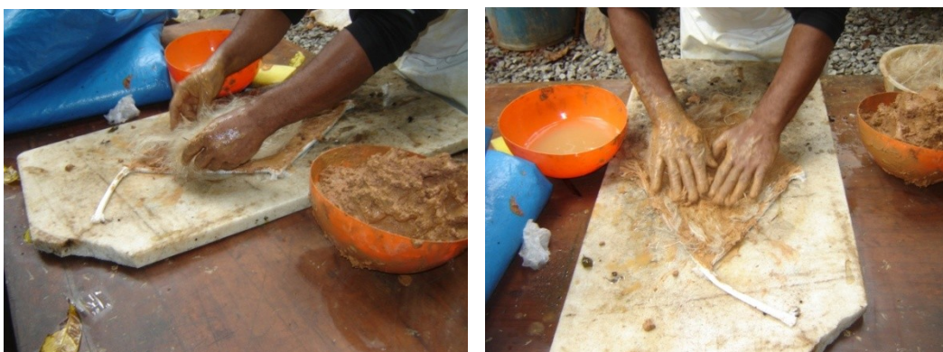
Figura 11: Nova camada de sisal sendo espalhada sobre a mistura. Mescla de barro sendo pressionada com os dedos sobre esta nova camada de fibras. Ao lado estão tigelas com mescla de barro, sisal e água para umedecer as mãos, no processo de confecção da manta.
