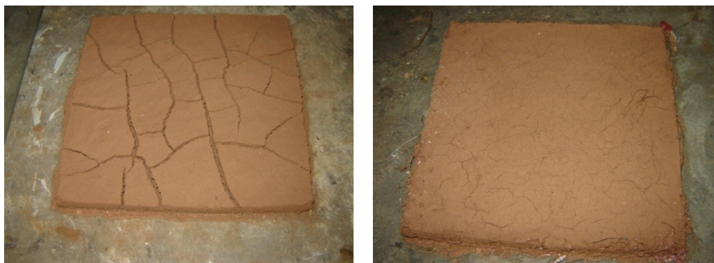
Figura 16: Placa de barro seccionada por grandes sulcos devido à retração durante a secagem. À direita, placa de fibrobarro confeccionada com a mesma mescla, percebendo-se rachaduras superficiais em maior quantidade e estreitas, resultado da maior coesão.
