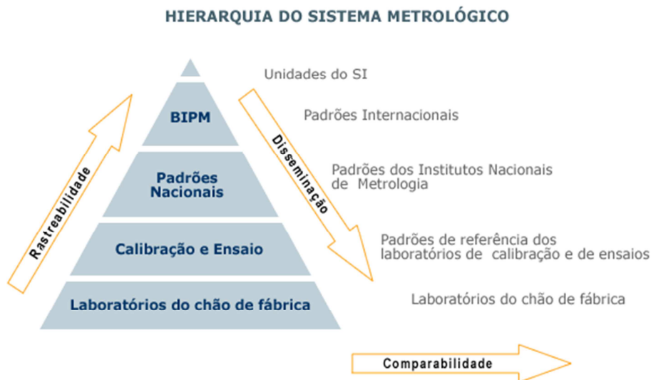
Figura 9: Estrutura Hierárquica de Rastreabilidade
