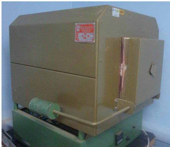
Figura 3.11 – Mufla de 440 °C usada para as misturas solo-cinza do laboratório de Geotecnia e Meio Ambiente da PUC-Rio.
