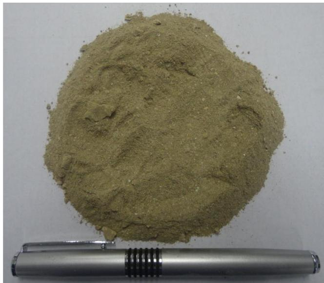
Figura 3.4 – Cinza Volante de RSU
