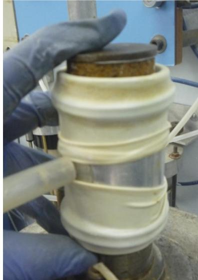
Figura 3.21 – Colocação do papel filtro e a pedra porosa no topo do corpo-de-prova
