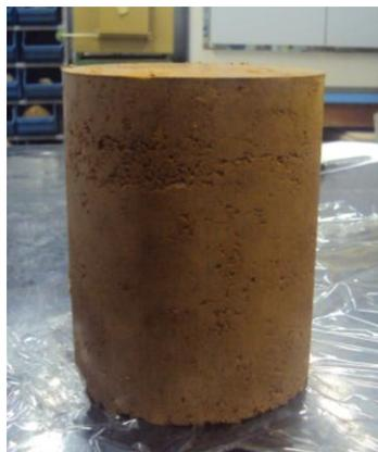
Figura 3.14 - Corpo cilíndrico compactado
