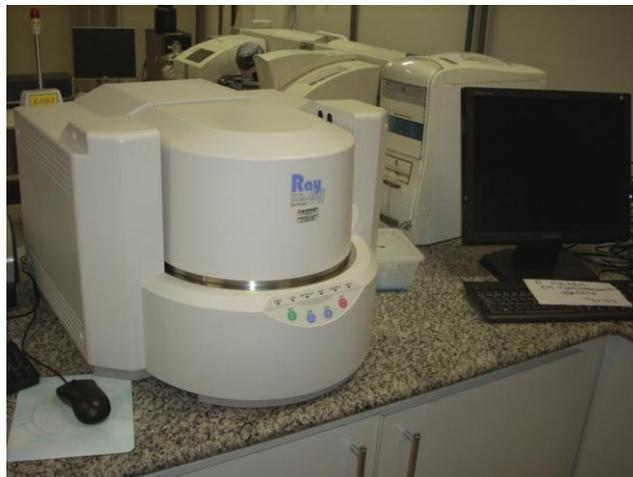
Figura 3.10 – Equipamento de EDX do LABEST da COPPE/UFRJ (Vizcarra, 2010)
