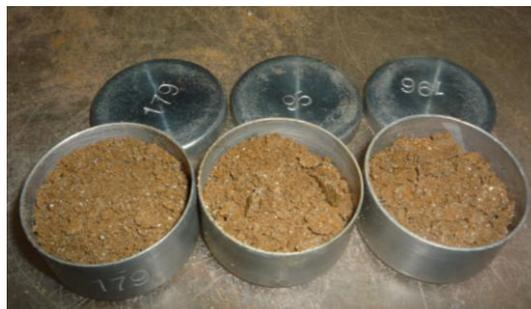
Figura 3.16 – Cápsulas com mistura de solo-cinza tirados do moldagem
