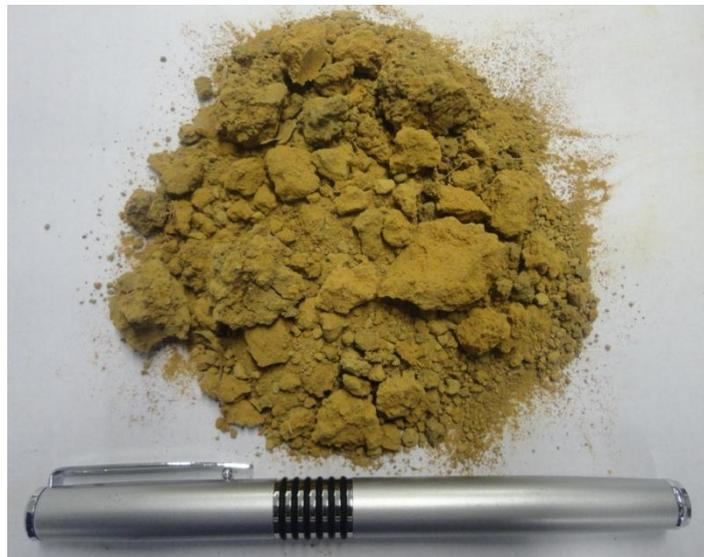
Figura 3.2 – Argila utilizada - solo coluvionar.
