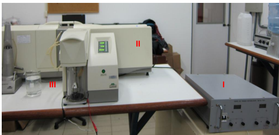
Figura 6 - Configuração experimental usada na medição do tamanho da bolha: I) DC fonte de alimentação; II) Metasizer 2000; III) célula de eletroflotação
