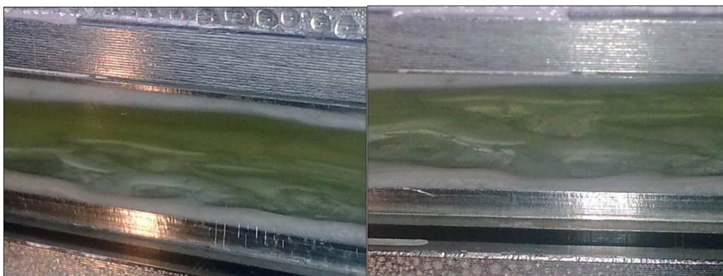
Figura 3-27 - Imagens do depósito para vazões superiores a 883 L/h, mostrando a formação de sulcos e irregularidade na espessura do depósito.
