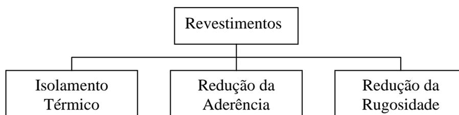
Figura 2-9 - Diagrama esquemático sobre a influência dos revestimentos na deposição de parafina.
