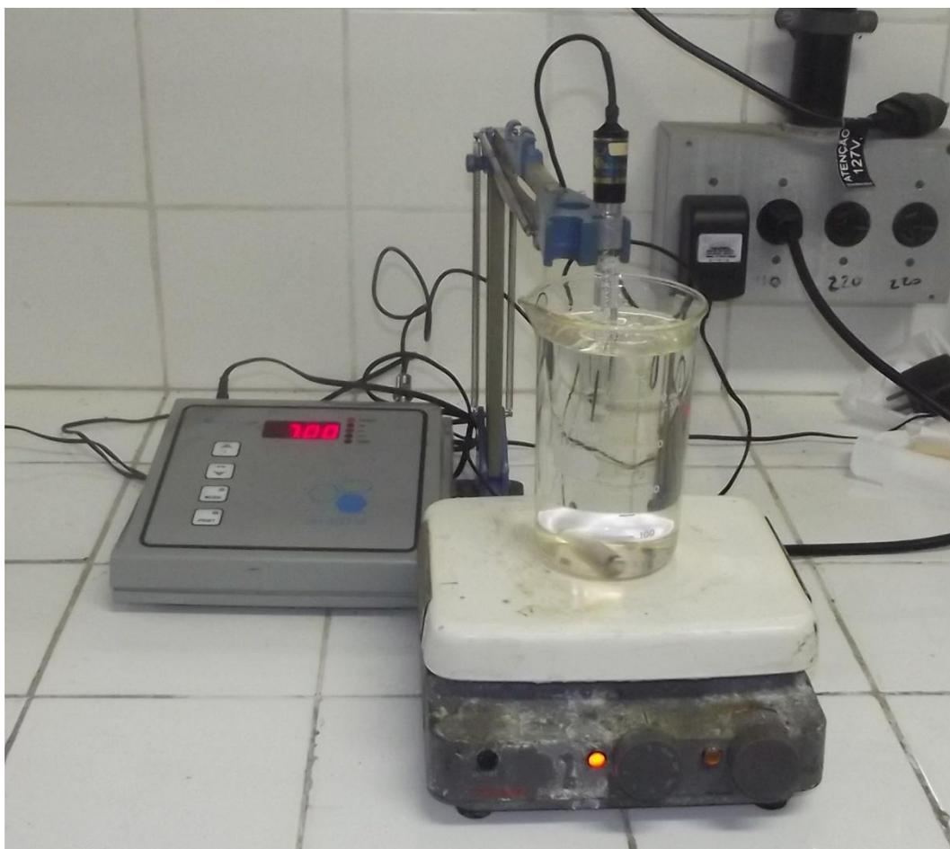
**Figura 9** Reator montado para a oxidação do cianeto.
