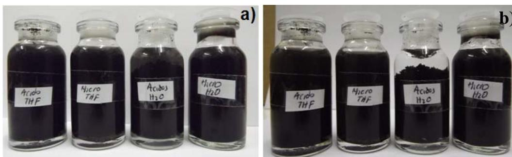
Figura 6.16. Dispersão dos MWCNTs tratados pro FC e FM em água e THF. a) após aplicação de ultrassom, b) após três dias.
