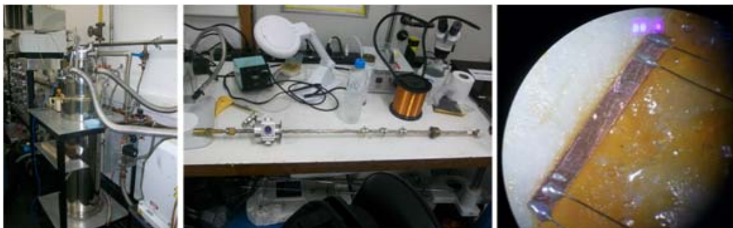
Figura 5.11. Imagem da esquerda corresponde ao criostato utilizado para introduzir o porta amostras (imagem central). A imagem da direita corresponde à amostra do nanocompósito já fixada com os fios condutores da porta amostra utilizando tinta prata condutiva de alta pureza.
