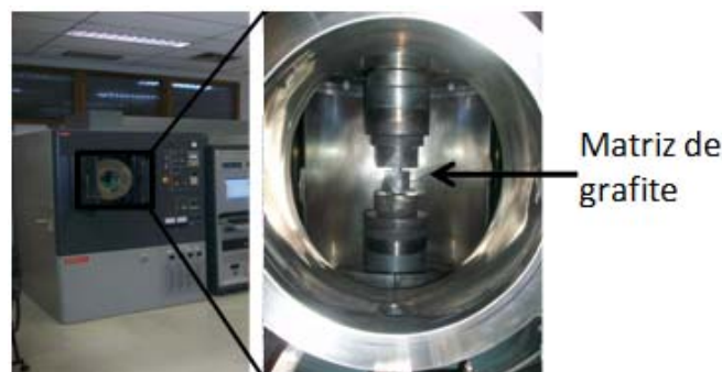
Figura 5.9 Imagem do equipamento SPS mostrando a câmara onde é colocada a matriz de grafite contendo o nanocompósito em pó.
