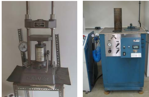
Figura 5.8 Prensa usada para compactação uniaxial (imagem esquerda) e prensa usada para compactação isostática a frio (imagem direita).
