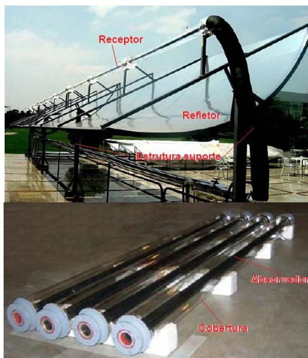
Figura 1.4 – Partes de um coletor concentrador linear parabólico [5]
