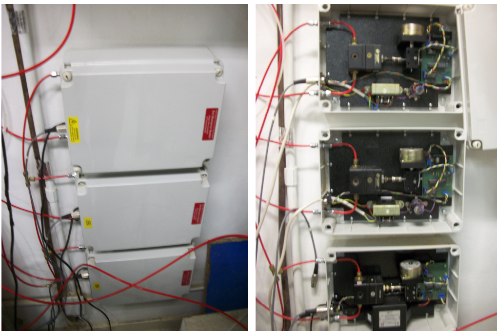
Figura 3.8. Caixas que regulam as pressões que são aplicadas durante o ensaio.
