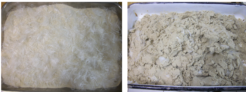
Figura 3.10: Mistura da areia com as fibras e a água necessária para atingir 10% de umidade.
