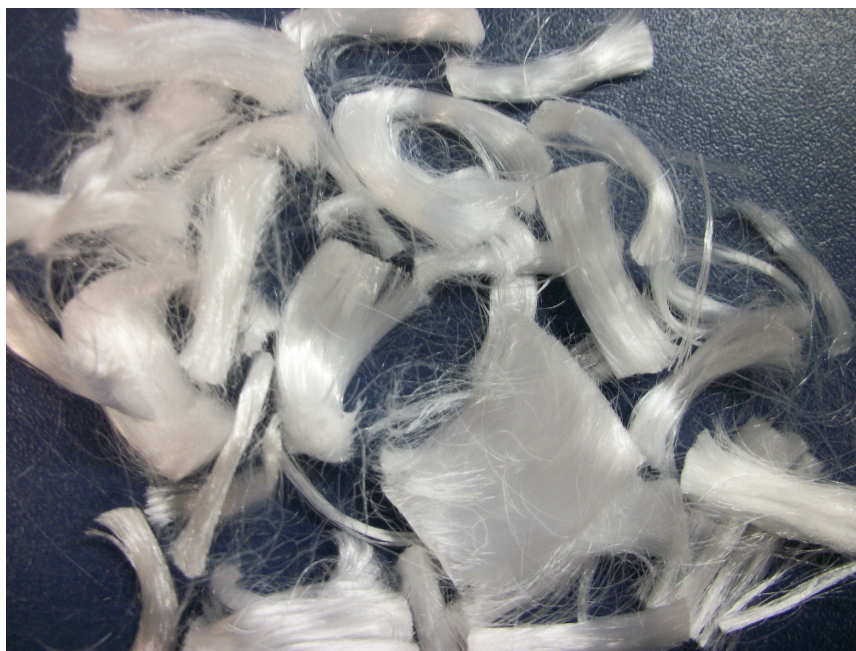
Figura 3.2: Aspecto das fibras de polipropileno com 19.3 mm de comprimento e 0.03 mm de diâmetro.
