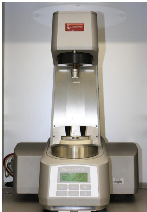
**Figura 3-4:** Reômetro Physica MCR 501 do laboratório de Reologia da PUC-RIO.
