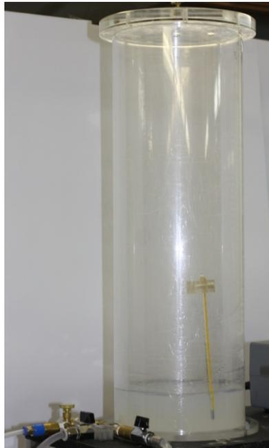
**Figura 2-4:** Reservatório com tampa e termômetro.
