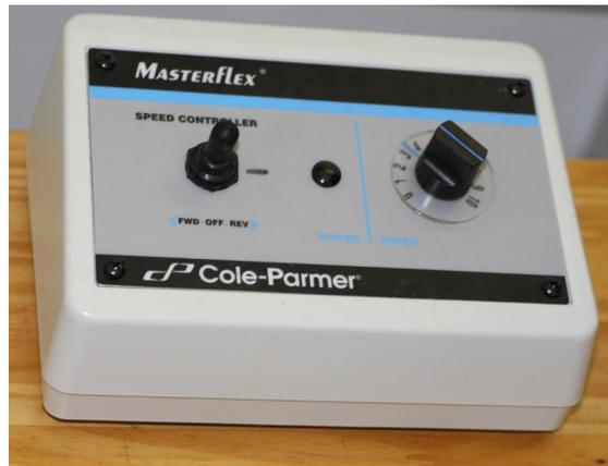
**Figura 2-6:**Controlador da vazão da bomba.
