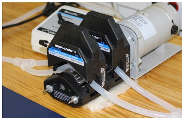
**Figura 2-5:** Bomba de deslocamento positivo (Cole Parmer EW-07553-70).
