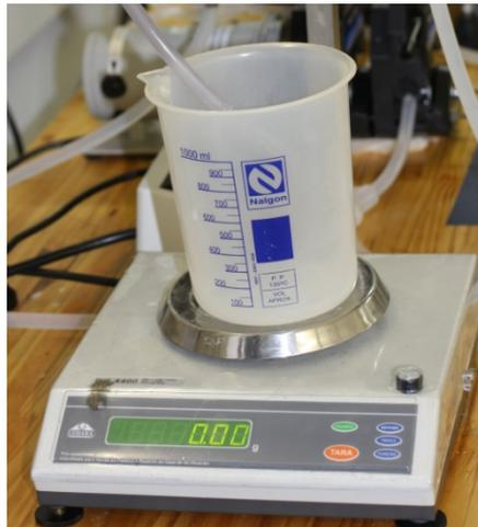
**Figura 2-14:** Balança Gehaka utilizada para medir a vazão.
