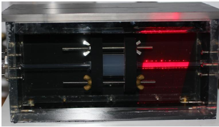
**Figura 2-17:** Calibração da posição do laser.
