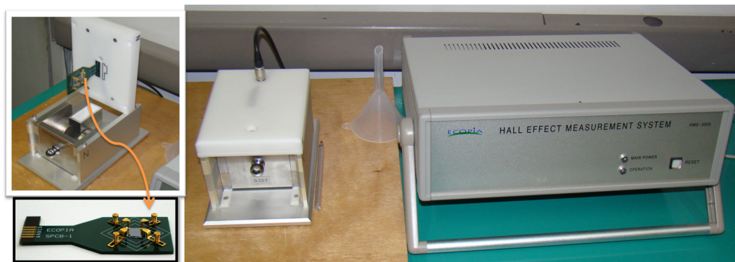
Figura 3.9: Equipamento de medida e porta amostra para medidas de efeito Hall da ECOPIA Hall Effect Measurement System HS 3000.
