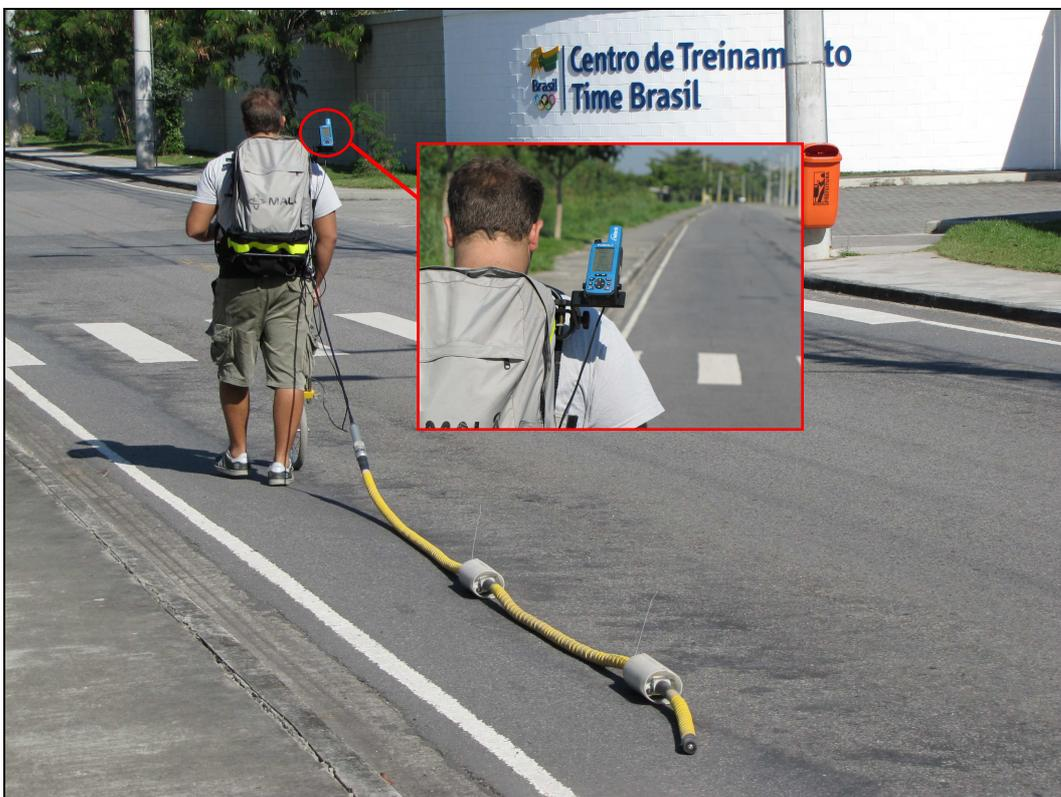
Figura 3.13 – Receptor do GPS geodésico acoplado ao GPR.
