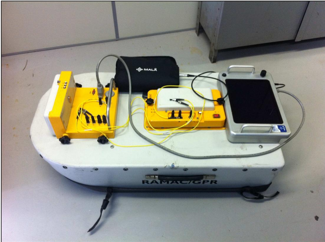
Figura 3.20 – Antena blindada de 250 MHz com a unidade controle, computador e as baterias do sistema GPR.
