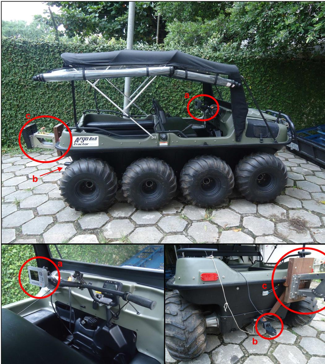
Figura 3.6 – Veículo Anfíbio adaptado para os equipamentos. (a) Tela do Sonar com receptor GPS, (b) Sonar e (c) Suporte para o motor de popa.
