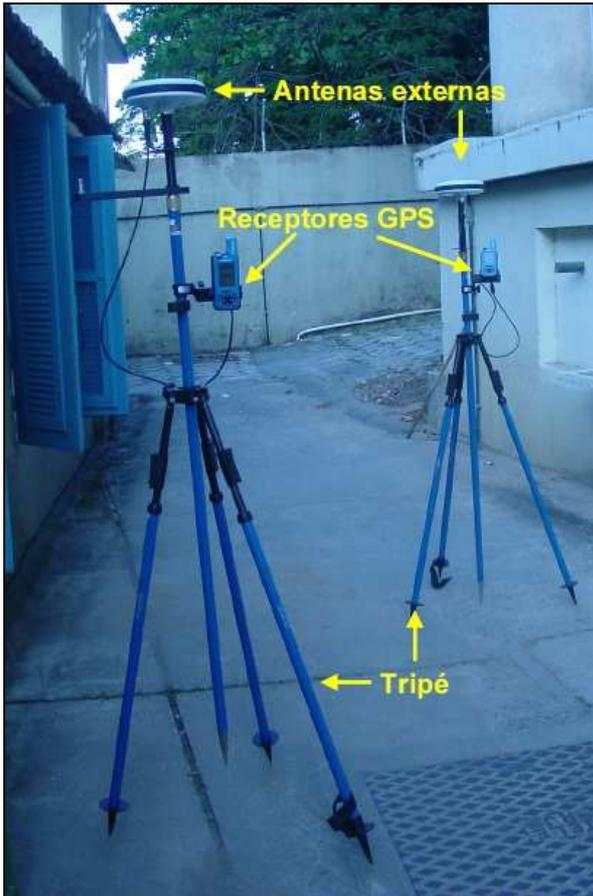
Figura 3.12 – Sistema GPS geodésico com seus acessórios (Souza, 2005).
