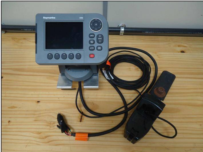
Figura 3.14 – Sonar integrado ao GPS da *Raymarine Inc.*
