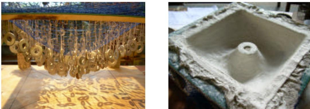
Figura 39 - Dispositivo utilizado para a obtenção da forma inicial, e deformado para a obtenção da forma incidental - (CAMPOS, 2009).
