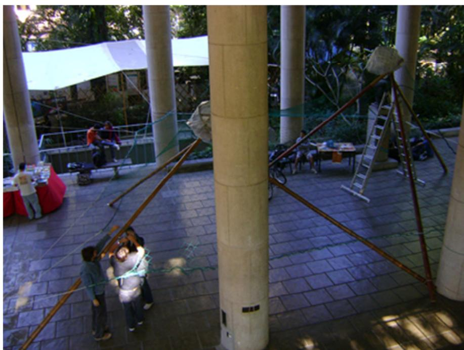
Figura 102 - Experimento de montagem de parte da estrutura de bambu com rede em escala 1:1
