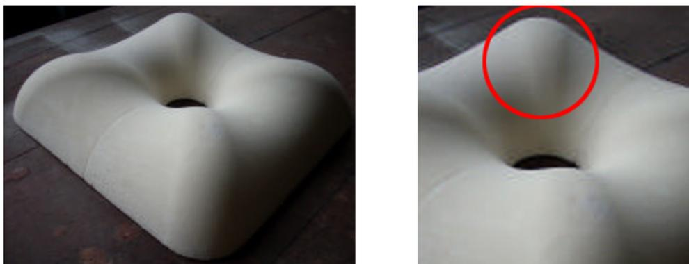
Figura 54 - Forma fresada resultante do modelo eletrônico, detalhe para a descontinuidade - (CAMPOS, 2009).
