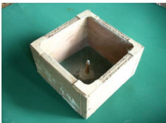
Figura 37 - Dispositivo para obtenção de modelos em escala menor - (CAMPOS, 2009).
