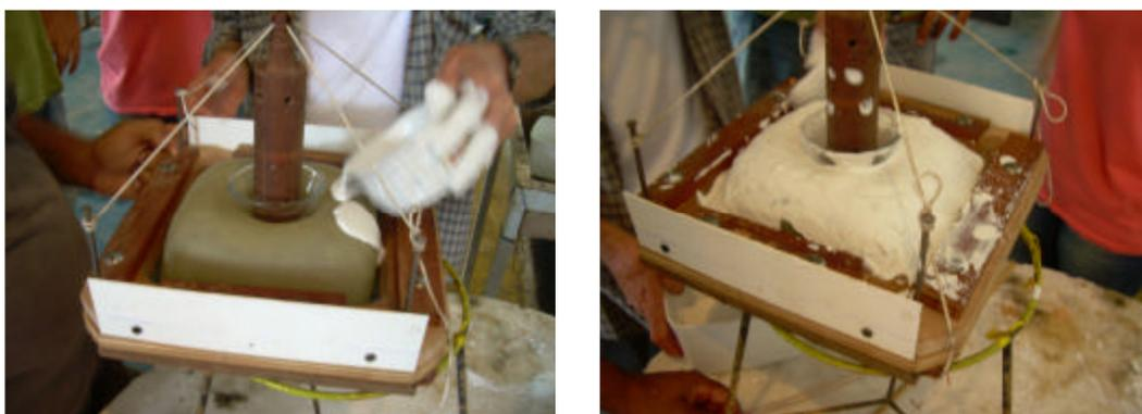
Figura 47 - Dispositivo utilizado para inflar uma membrana de látex e aplicação de gesso para confecção de molde – (CAMPOS, 2009).
