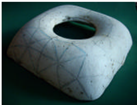
Figura 29 – Modelo em gesso escaneado para a geração de modelo eletrônico – (CAMPOS, 2009).
