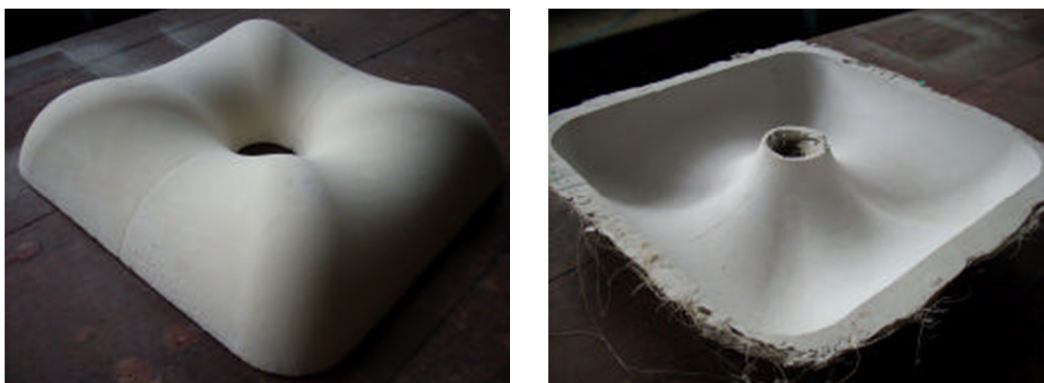
Figura 32 – Modelo confeccionado em fresa CNC e molde negativo em gesso – (CAMPOS, 2009).
