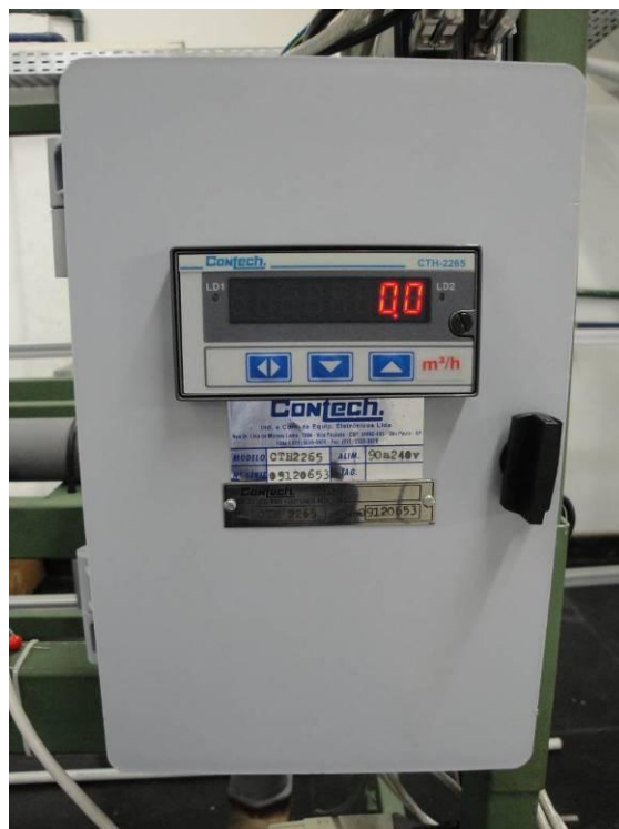
Figura 5.15 – Indicador e totalizador do medidor de vazão tipo turbina (Fonte: Manual da Contech).
