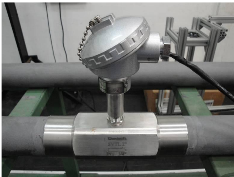
Figura 5.12 – Medidor de vazão tipo turbina Contech, série SVT-L, modelo L19 utilizado nos ensaios para medir a vazão de alívio da válvula.
