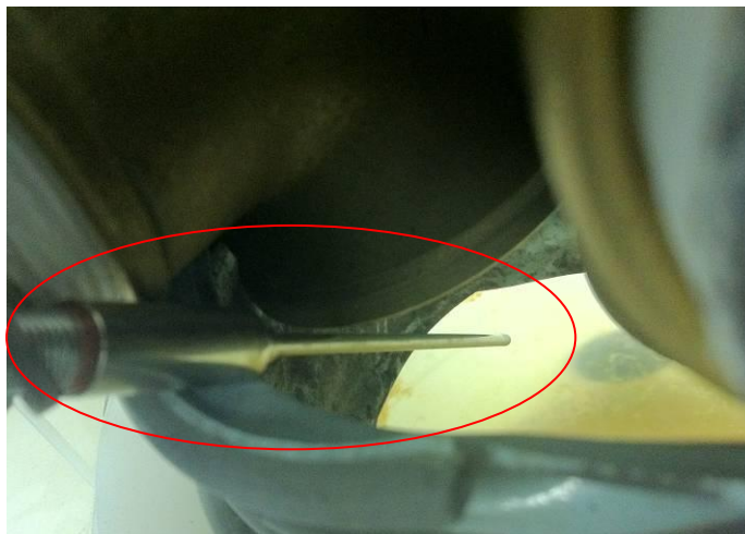
Figura 5.21 – Sensor de temperatura da água do tipo PT100 instalado na linha de retorno da seção de testes.
