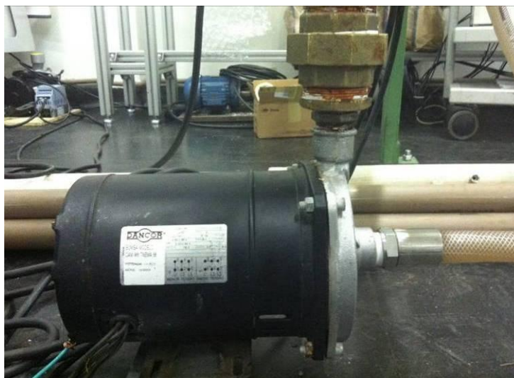
Figura 5.4 – Fotografia da bomba DANCOR, modelo CAM-W6C, utilizada nos ensaios.
