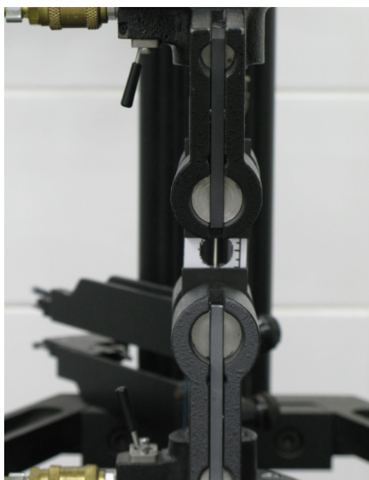
Figura 15 – corpo de prova posicionado na máquina de ensaios universal
