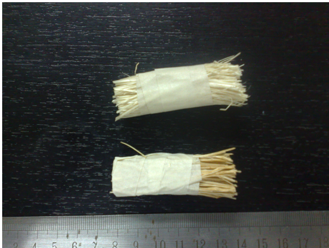
Figura 12 – feixes de fibra a serem embutidos em resina Epóxi
