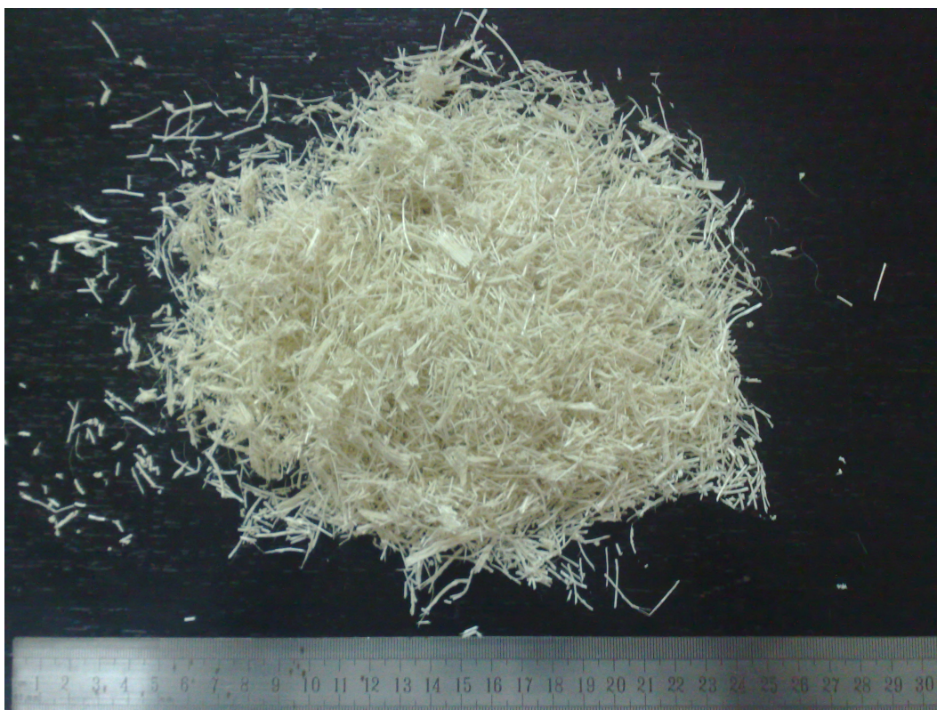
Figura 10 – Fibras beneficiadas no triturador elétrico
