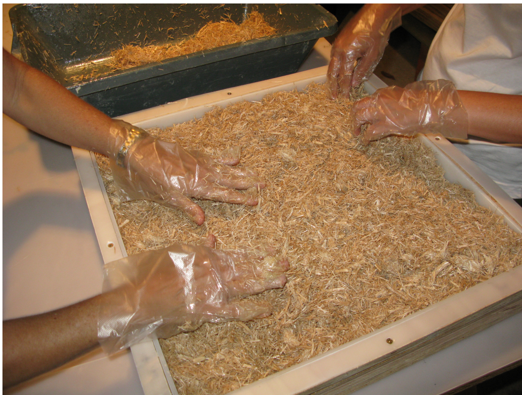
Figura 16- montagem do colchão de fibras embebidas em resina
