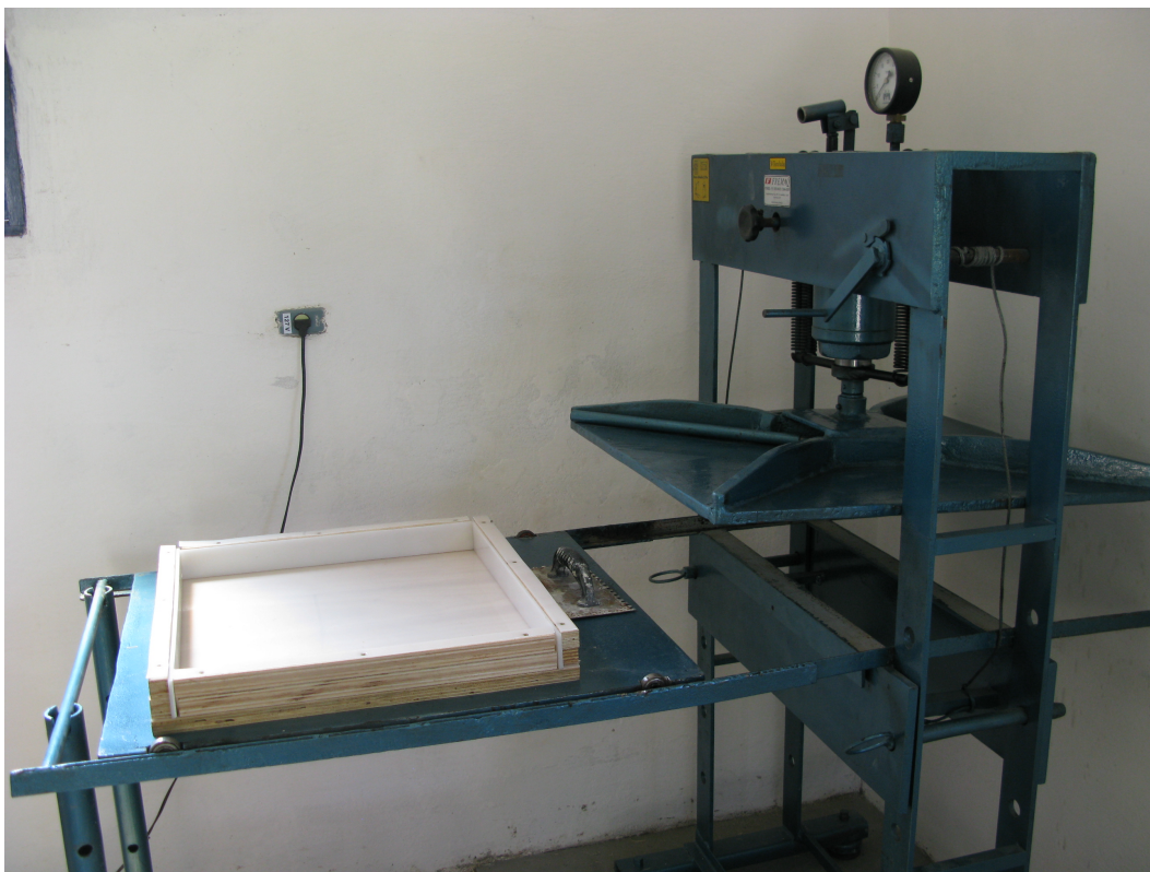
Figura 17 – prensa e forma utilizadas para a confecção das placas
