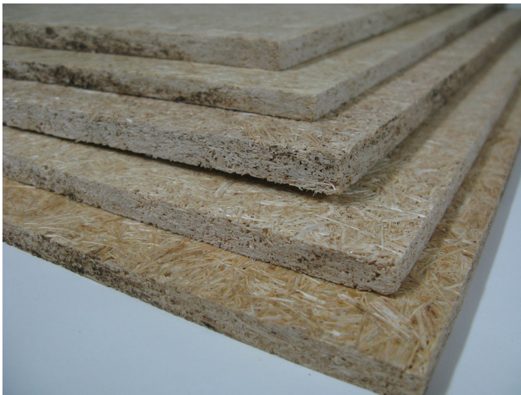
Figura 18 - Chapas de fibras de Pupunha (10mm de espessura)
