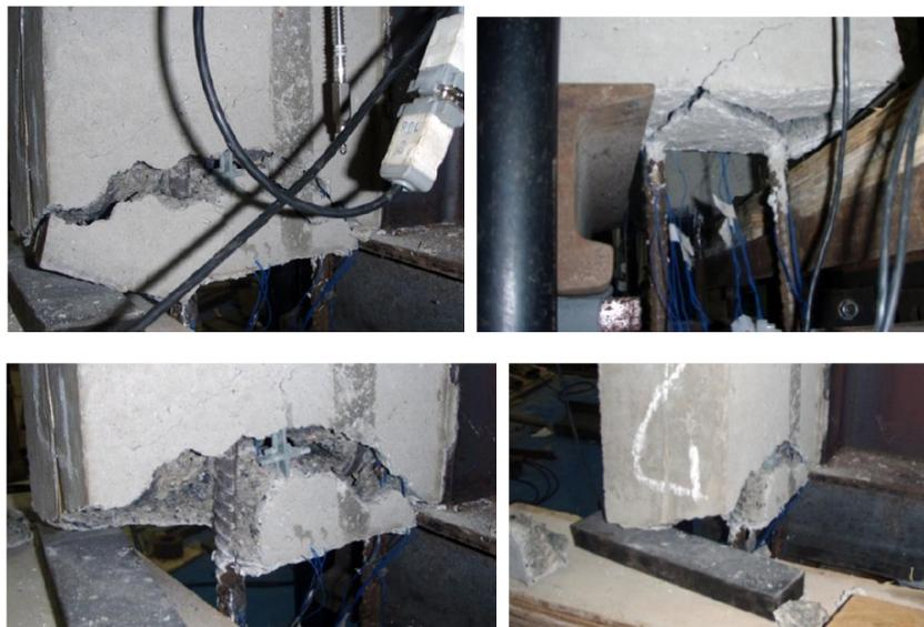
Figura 5.78 – Ruptura da ancoragem da barra de armadura do ensaio PO-83
