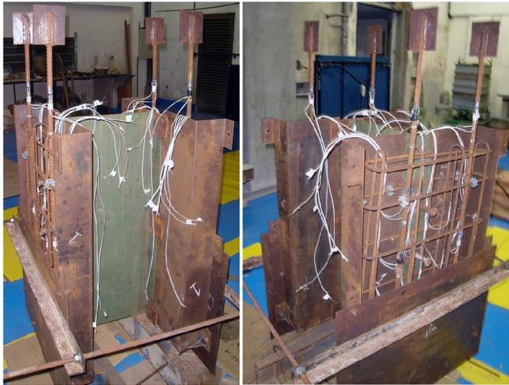
Figura 5.35 – Posicionamento de Concretagem do Pull-out
