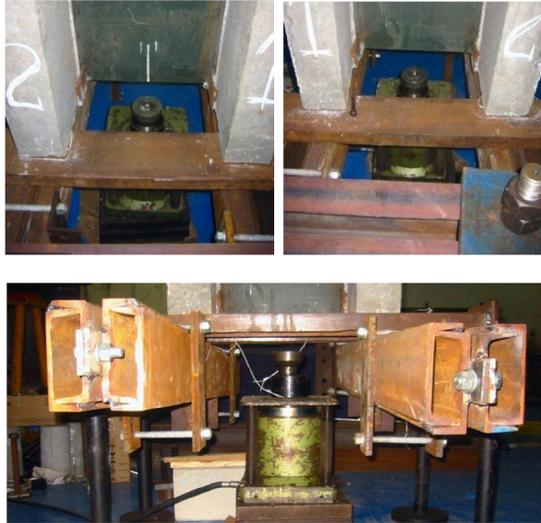
Figura 5.38 –Atuador Hidráulico Sem a Cabeça Rotulada
