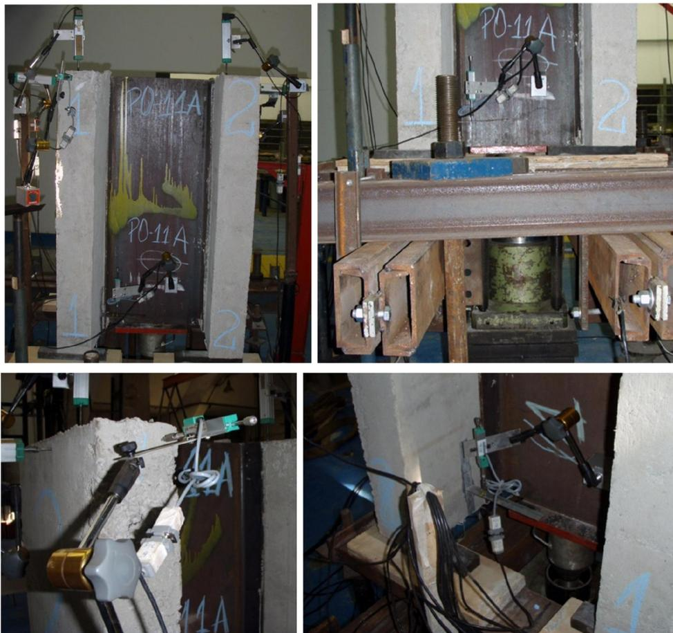
Figura 5.62 – Posicionamento dos LVDT's
