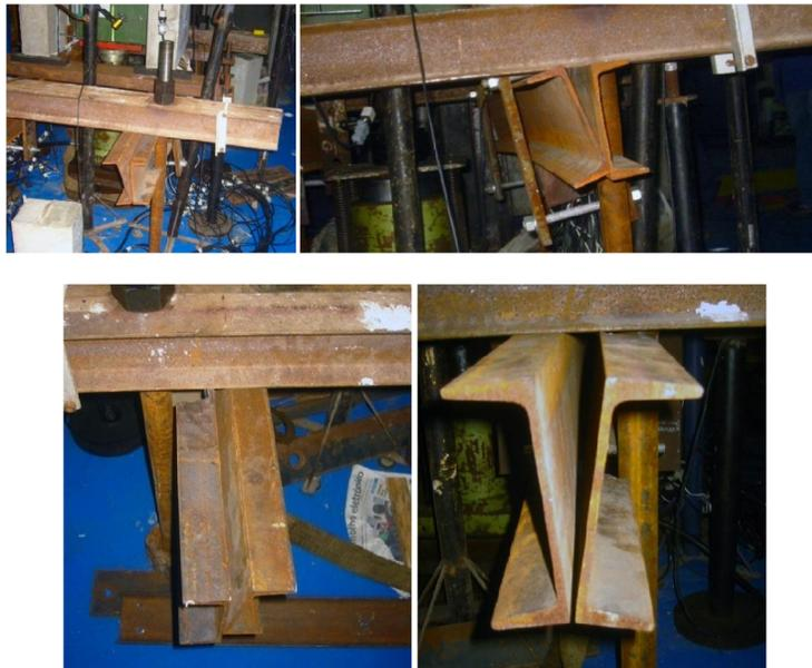
Figura 5.39 – Flambagem dos Perfis de Travamento do Primeiro Nível
