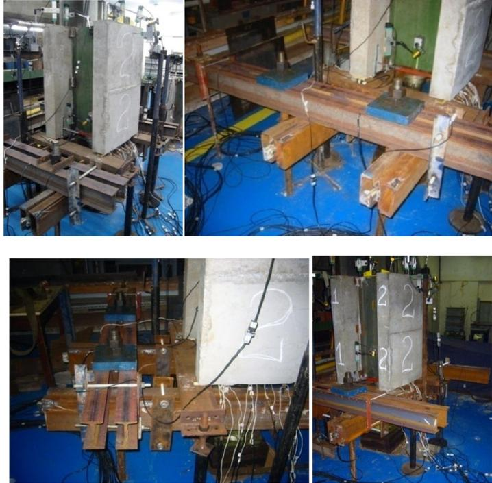
Figura 5.20 – Estrutura de travamento e pull-out prontos para a execução do teste.
