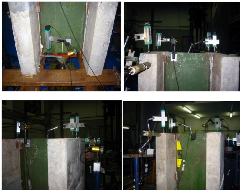
Figura 5.31 – Posicionamento dos LVDT's
