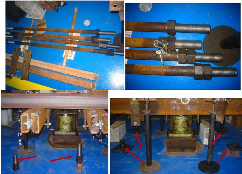
Figura 5.14 – Barras redondas posicionadas nos furos
