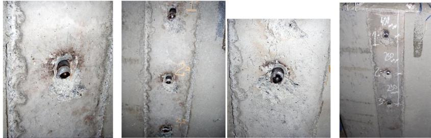
Figura 5.66 – Detalhe das rupturas das soldas dos conectores
