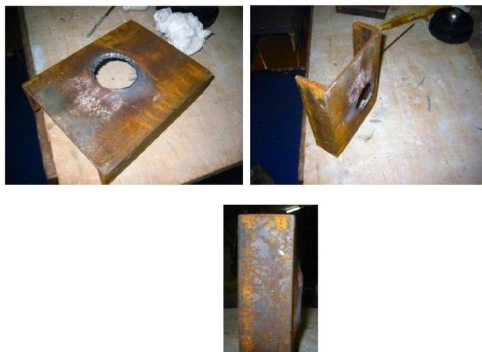
Figura 5.43 – Arruelas com Afundamento
