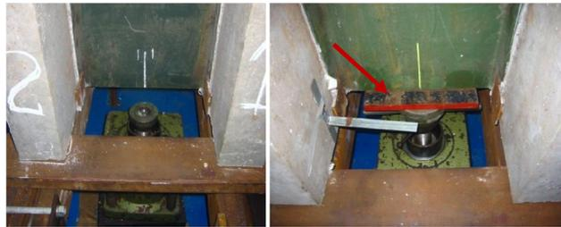
Figura 5.16 – Placa de distribuição de tensões
