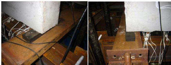
Figura 5.15 – Pontos de apoio em neoprene
