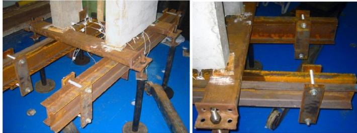
Figura 5.18 – Estrutura de fixação e travamento dos perfis
