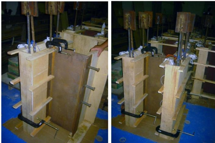
Figura 5.64 – Montagem da Forma para a Concretagem do Pull-out
