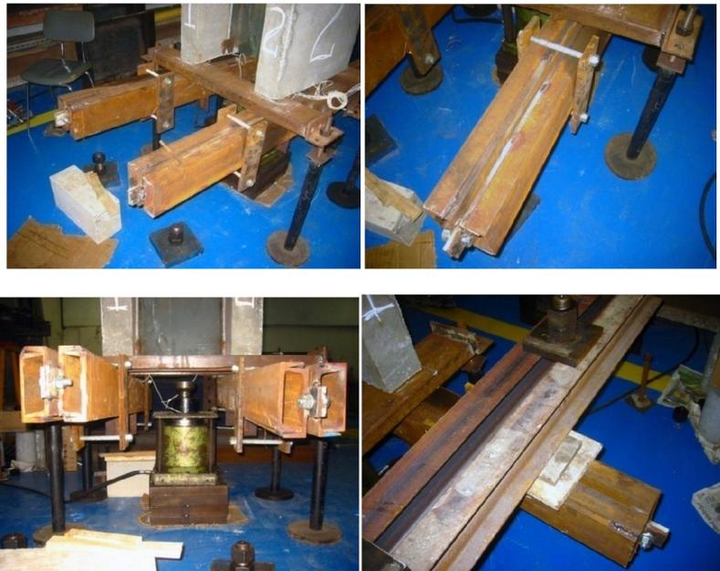
Figura 5.2 – Sistema de travamento com vigas metálicas
