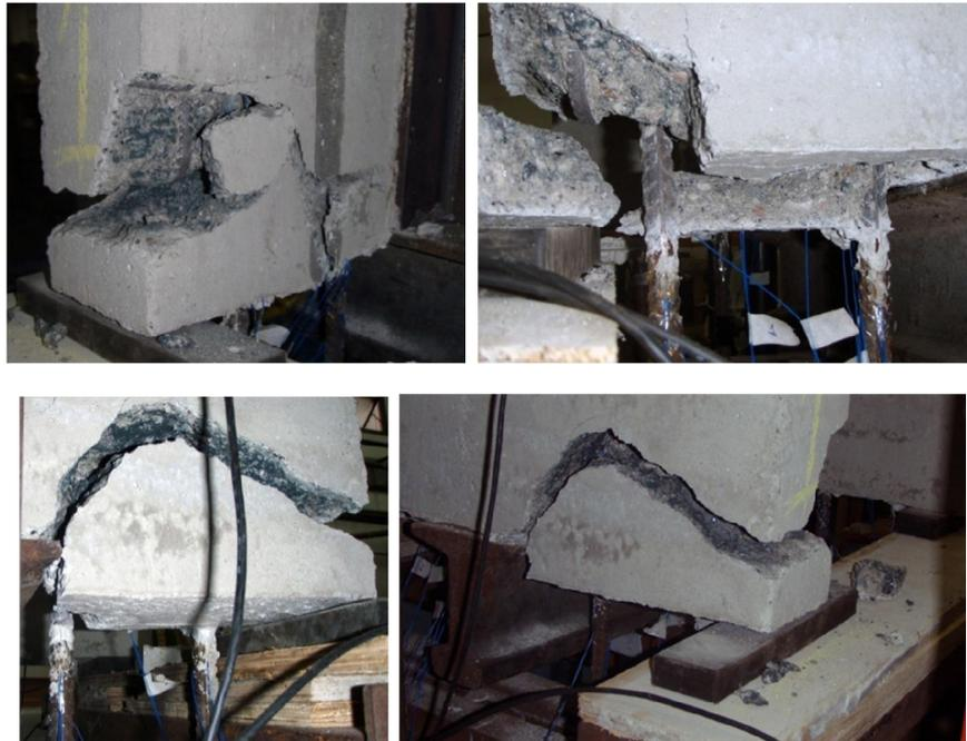
Figura 5.77 – Ruptura da ancoragem da barra de armadura do ensaio PO-82
