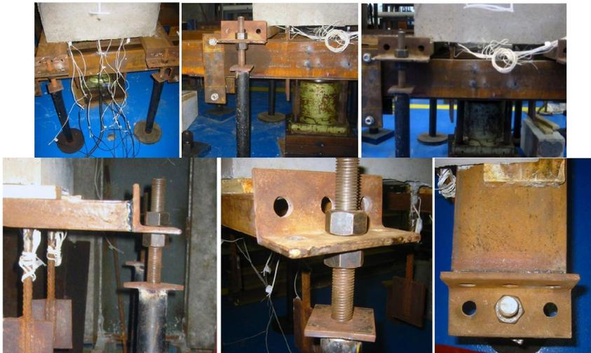
Figura 5.13 – Mesinhas de apoio dos pull-out's
