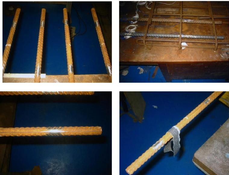
Figura 5.3 – Posicionamento dos extensômetros
