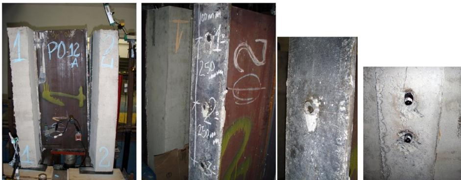
Figura 5.65 – Ruptura da solda dos conectores de cisalhamento
