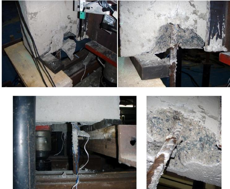
Figura 5.73 – Ruptura da ancoragem da barra de armadura do ensaio PO-72
