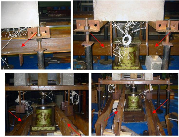
Figura 5.17 – Placas de apoio dos perfil de travamento
