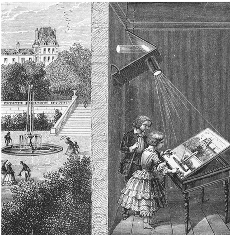
Figura 1. Ilustração de um modelo de *camera obscura*, no qual se expõe o seu diagrama de funcionamento.
