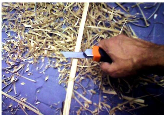
Figura 106 – Posição correta para uso de estiletes no preparo manual de lâminas de bambu *Phyllostachys*
