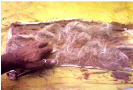
Figura 122 – Agregação da fibra de sisal ao barro
