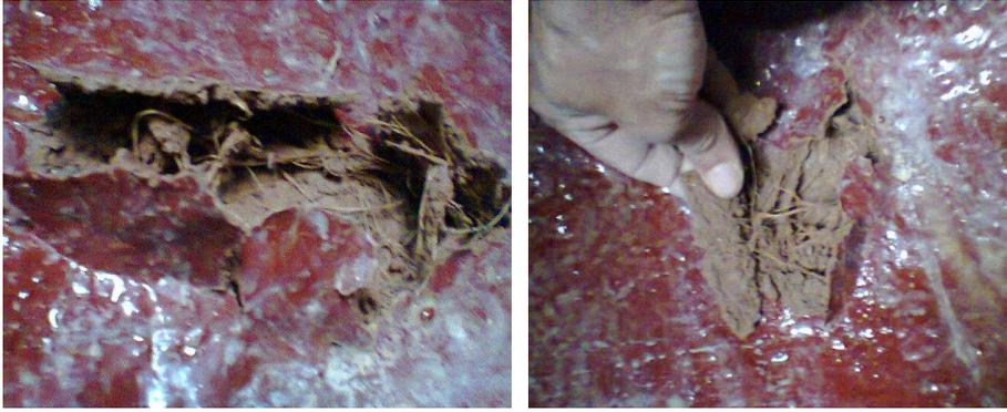
Figuras 199 e 200 – Rompimento das membranas interna e externa do modelo esférico 1
