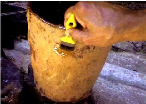
Figura 130 – Impermeabilização externa do Modelo 1
