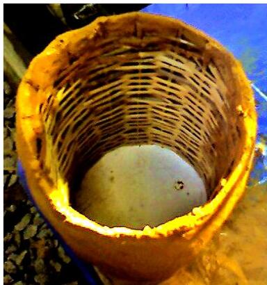
Figura 124 – Revestimento com “Fibrobarro”
