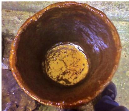
Figura 134 – Modelo impermeabilizado pela Resina de Mamona
