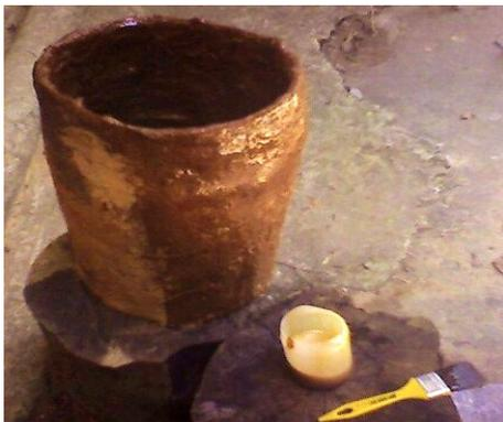
Figura 132 - Impermeabilização do Modelo 1
