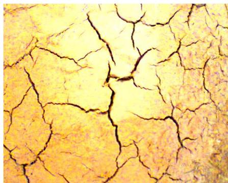
Figura 191 - Rachaduras provocadas pelo excesso de água
