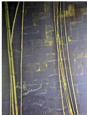
Figura 137 – Colmos de bambu *Phyllostachys Áurea*    Figura 138 – Lâminas de bambu
