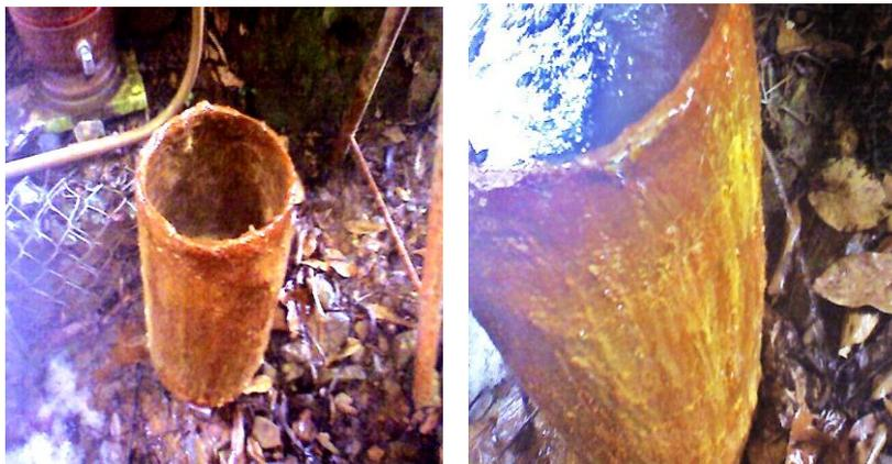
Figuras 135 e 136 – Observação de pontos de vazamento de água no modelo 1
