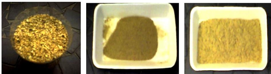
Figura 87 - Bambu triturado Figura 88 - Pó de Bambu médio Figura 89 - Pó de Bambu fino
