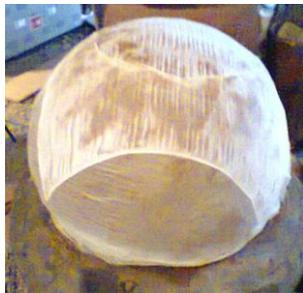
Figura 187 – Manta de algodão do tipo da fralda reforçando o “fibrobarro”
