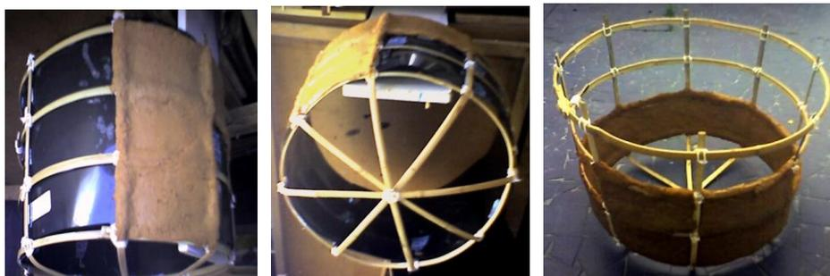
Figuras 153, 154 e 155 – Revestimento do modelo com “fibrobarro”
