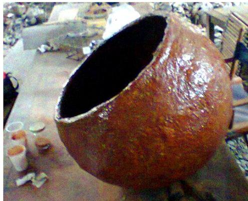
Figura 195 – Modelo 1 impermeabilizado com poliuretano vegetal
