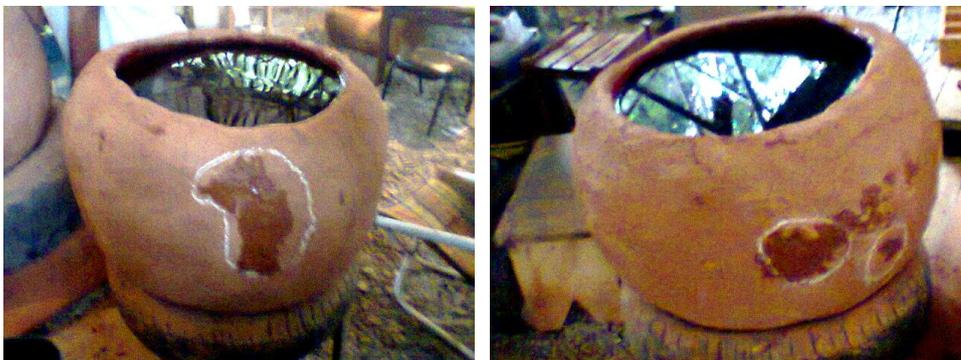
Figuras 204 e 205 – Micro vazamento no modelo 3
