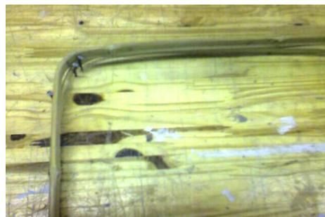
Figura 141 – Gabarito curvando lâmina de bambu      Figura 142 – Gabarito para curvar lâminas de bambu
