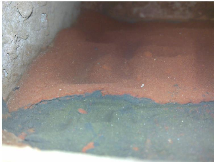
Figura 68 – Formação de uma camada reagida na superfície da amostra impedindo o progresso da reação sobre as demais regiões da amostra
