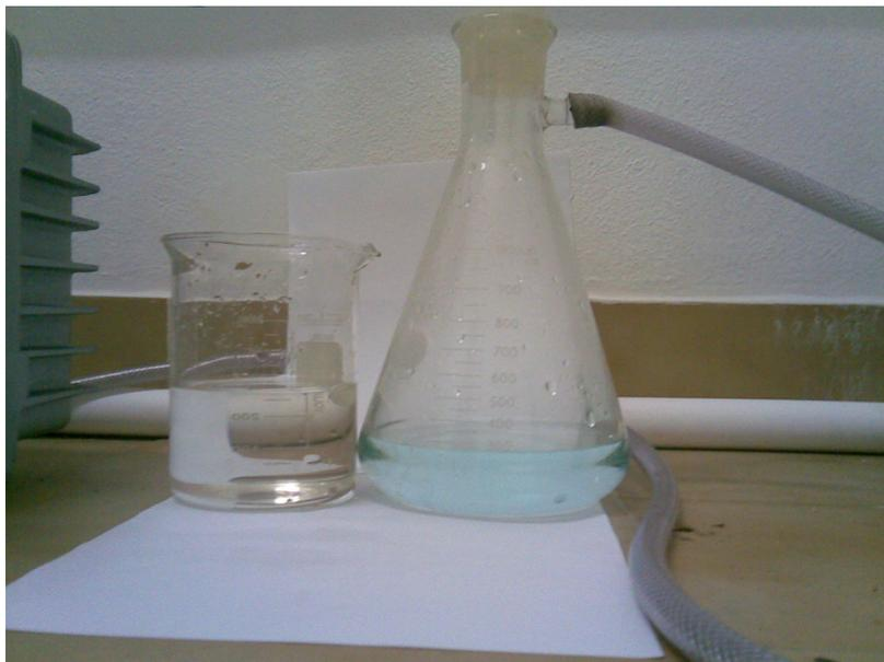
Figura 41 – Licor oriundo da solubilização de uma amostra proveniente de um ensaio de ustulação com ar atmosférico a 600 °C
