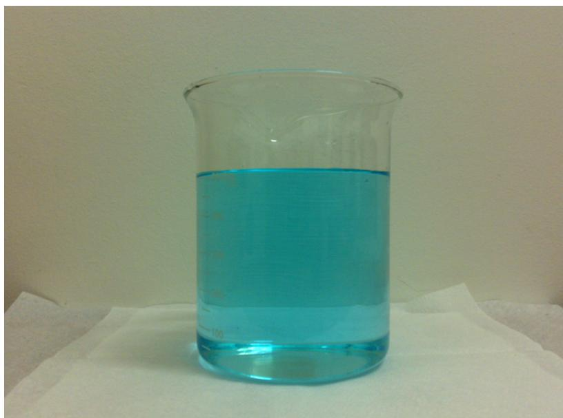
Figura 72 – Licor oriundo da solubilização de uma amostra proveniente de um ensaio de ustulação em maior escala iniciado a 500°C
