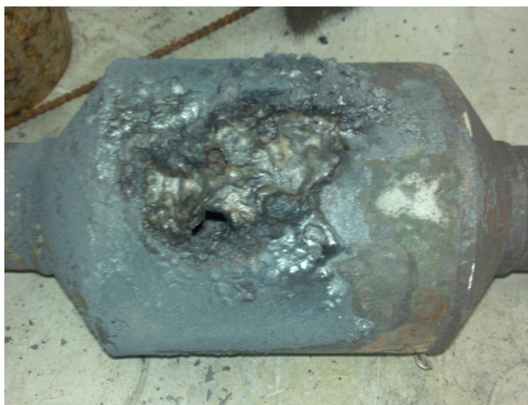
Figura 66 – Estado final da câmara reacional rotatória
