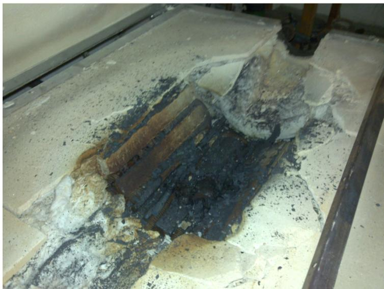
Figura 67 – Estado final das resistências elétricas e do material refratário
