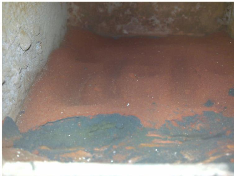
Figura 69 – Formação de uma camada reagida na superfície da amostra impedindo o progresso da reação sobre as demais regiões da amostra
