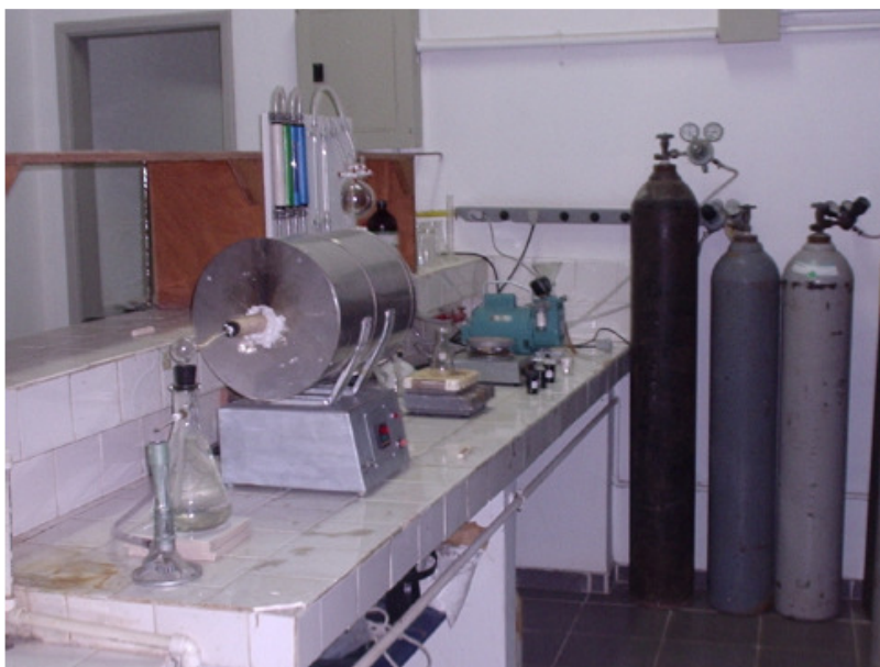
Figura 26 – Linha experimental de ustulação com ar atmosférico oriundo de um compressor
