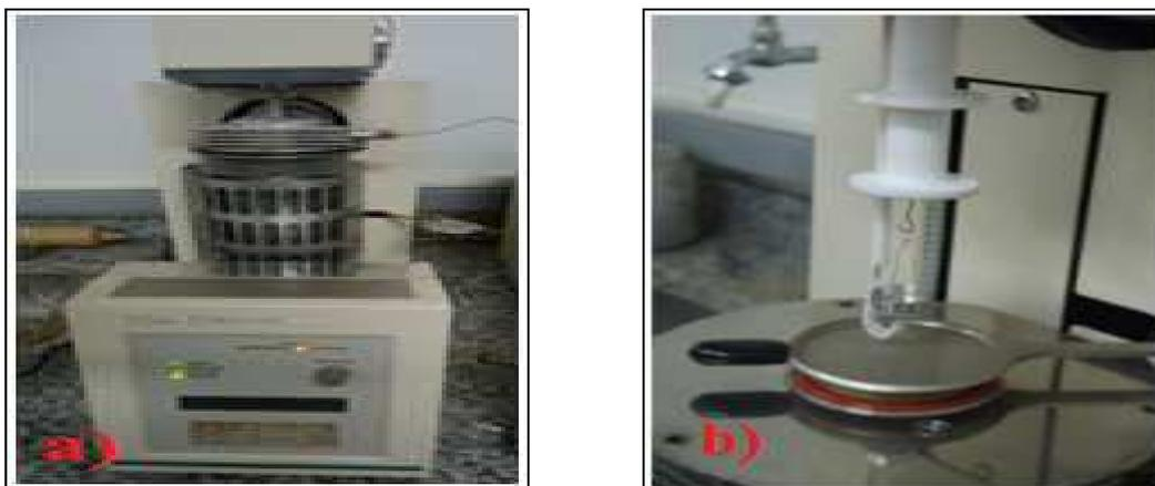
**Figura 35** – a) Balança termogravimétrica (TGA) b) Cadinho e cesto do analisador
