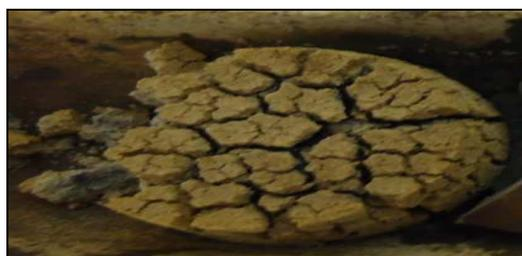
**Figura 30** - Pastilha de Carvão Mineral, antes e depois do ensaio de Reatividade, temperatura: 1100°C, tempo: 2 horas, atmosfera de CO<sub>2</sub>
