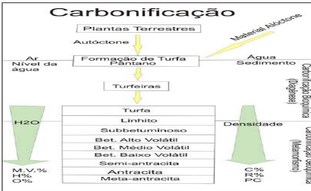
Figura 9 - Formação do carvão (MV: matéria volátil, PC: poder calorífico, R: refletância) (Ulhoa, 2003)
