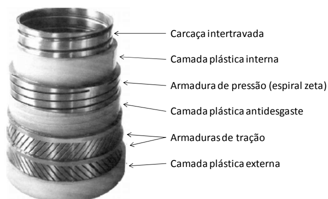
Figura 2 - Estrutura interna do duto flexível Fonte: Mbaye (2006)
