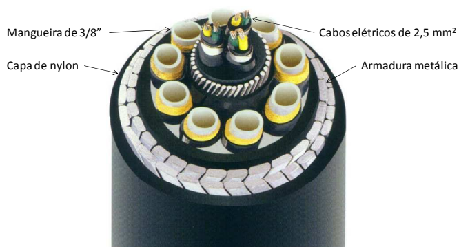
Figura 3 - Umbilical eletro-hidráulico Com nove mangueiras, três pares de cabos elétricos de 2,5\text{mm}^2 para aquisição de dados Fonte: Labanca (2005)
