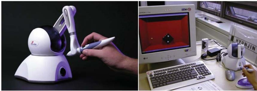
Figura 2.12: Dispositivo Háptico Phantom-Omni
