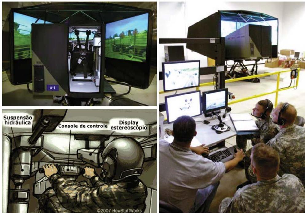
Figura 2.22: Simulador do veículo terrestre Stryker
