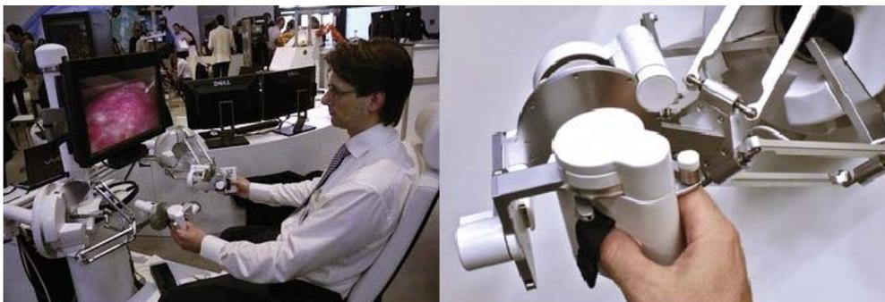
Figura 2.14: Dispositivo Háptico Sigma.7 Force Dimension
