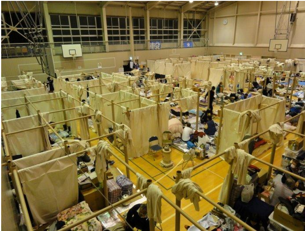
Ilustração 21 – Ginásio com refugiados do terremoto no Japão. Projeto do arquiteto Shigeru Ban. Usando bobinas de papel e papelão, projetou divisórias para dar mais privacidade às famílias. Foto retirada do site: http://www.spoon-tamago.com . Acesso em março de 2011.
