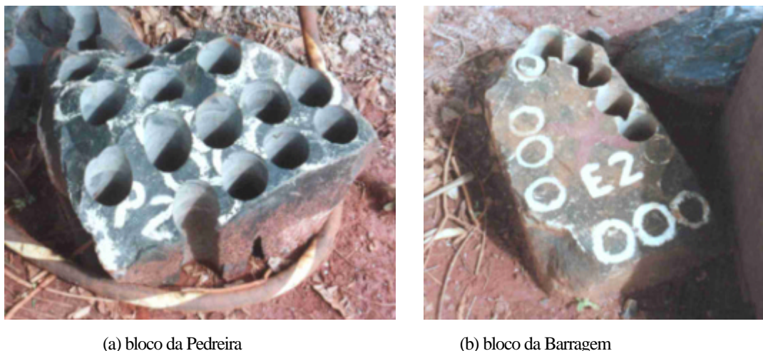
(a) bloco da Pedreira (b) bloco da Barragem Figura 5.3 - Extração de testemunhos dos blocos de basalto.
