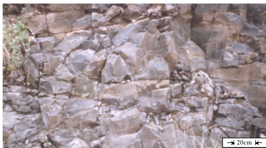
Figura 4.11 - Detalhe do fraturamento do maciço de basalto da Pedreira Rio Grande.
