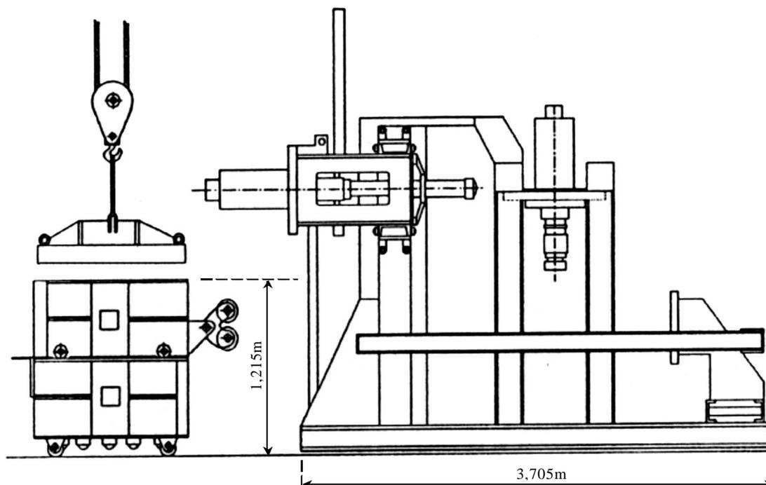
Figura 5.22 - Vista lateral do sistema de aplicação de carga horizontal suspenso e a caixa de cisalhamento posicionada para moldagem (CEDEX, Espanha).
