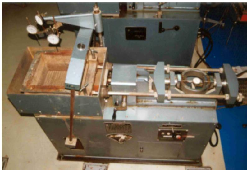
Figura 5.24 - Vista do equipamento de cisalhamento direto CIS<sub>30</sub> (CEDEX, Espanha).
