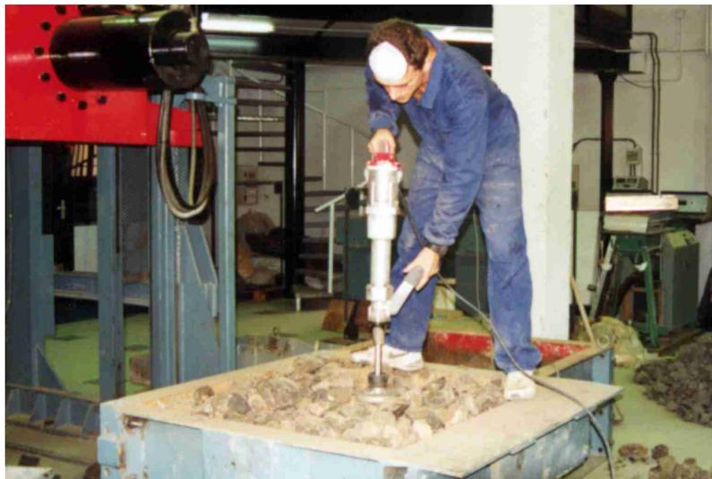
Figura 5.23 - Densificação dos corpos de prova cúbicos com 1,00m de lado para ensaios de cisalhamento direto (CEDEX, Espanha).
